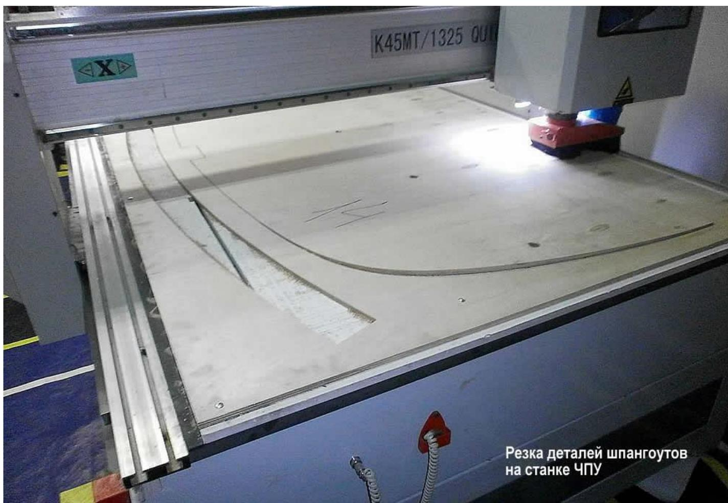
Резка шпангоутов на станке ЧПУ
