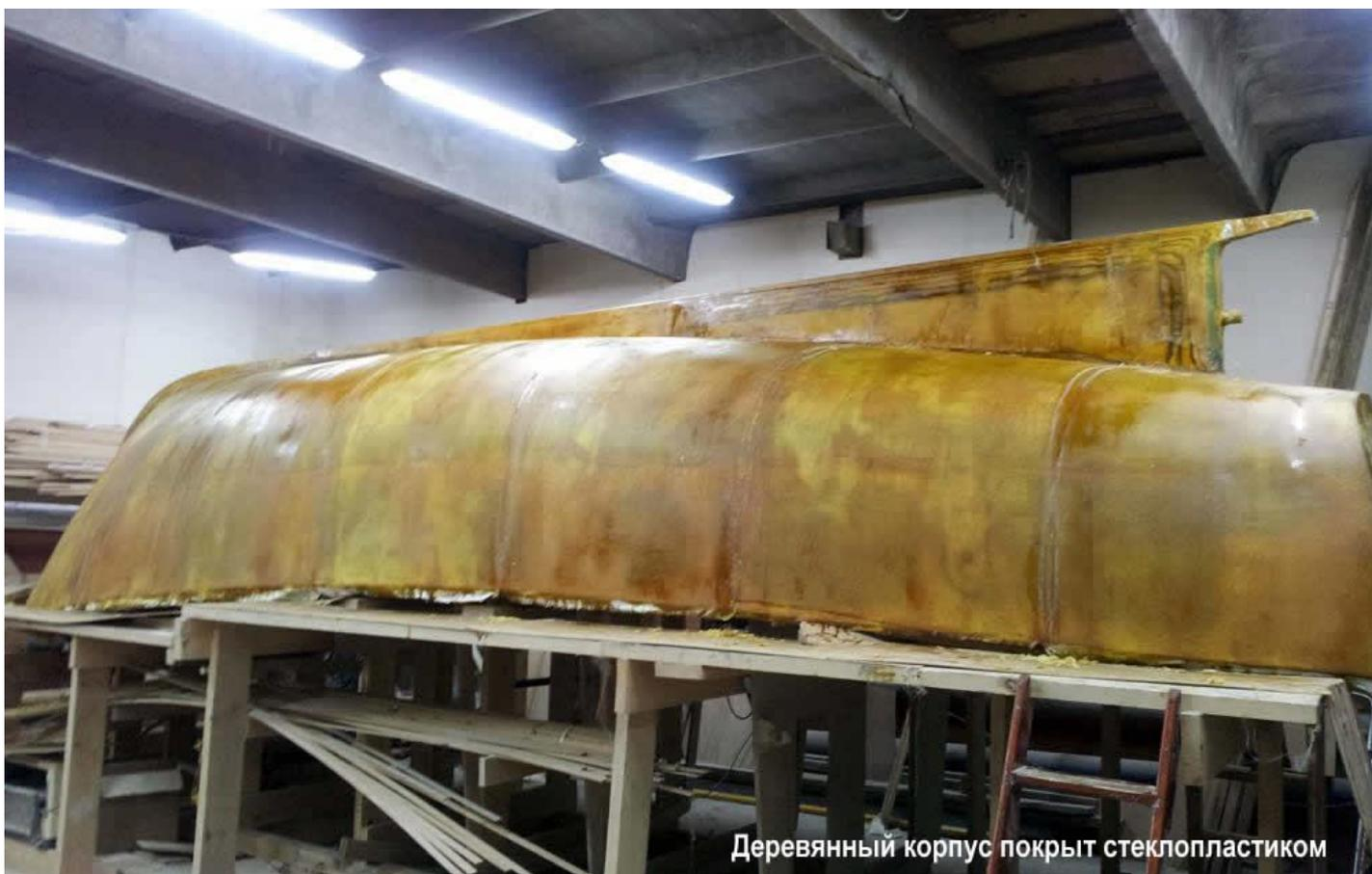
Деревянный корпус покрыт стеклопластиком
