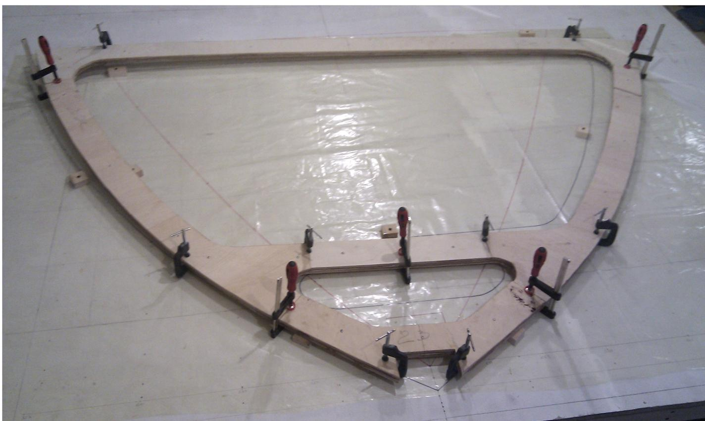
Сборка шпангоута из фанерных деталей на плазе.
