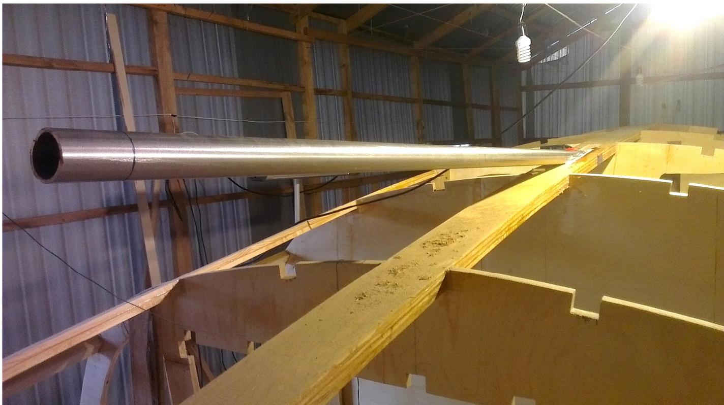
Врезка дубового кия и установка дейдвудной трубы
