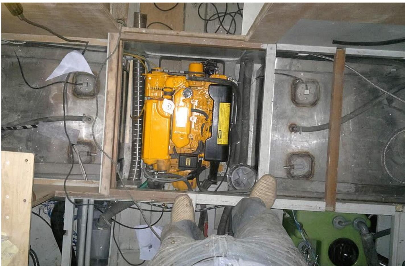
Монтаж двигателя и топливных танков
