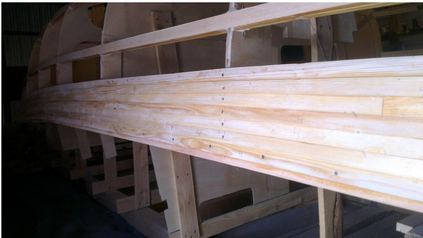
Начало продольной обшивки сосновой рейкой. Сборка на эпоксидной смоле.
