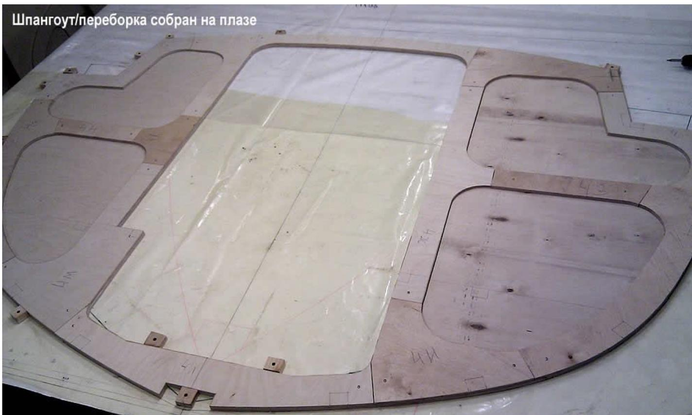
Сборка переборки на плазе
