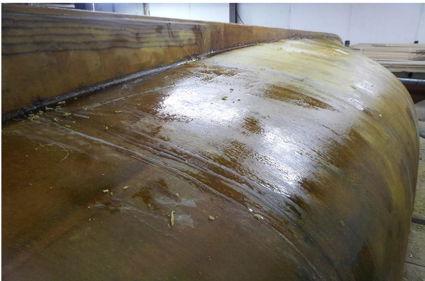
Оклейка корпуса стеклотканью на эпоксидной смоле
