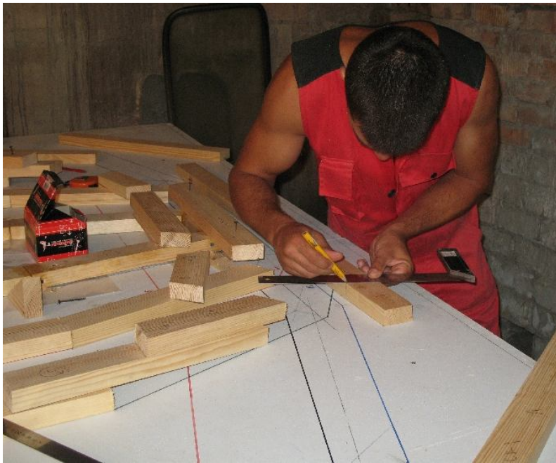
Рис 2. Разметка тимберсов шпангоута на плазе
