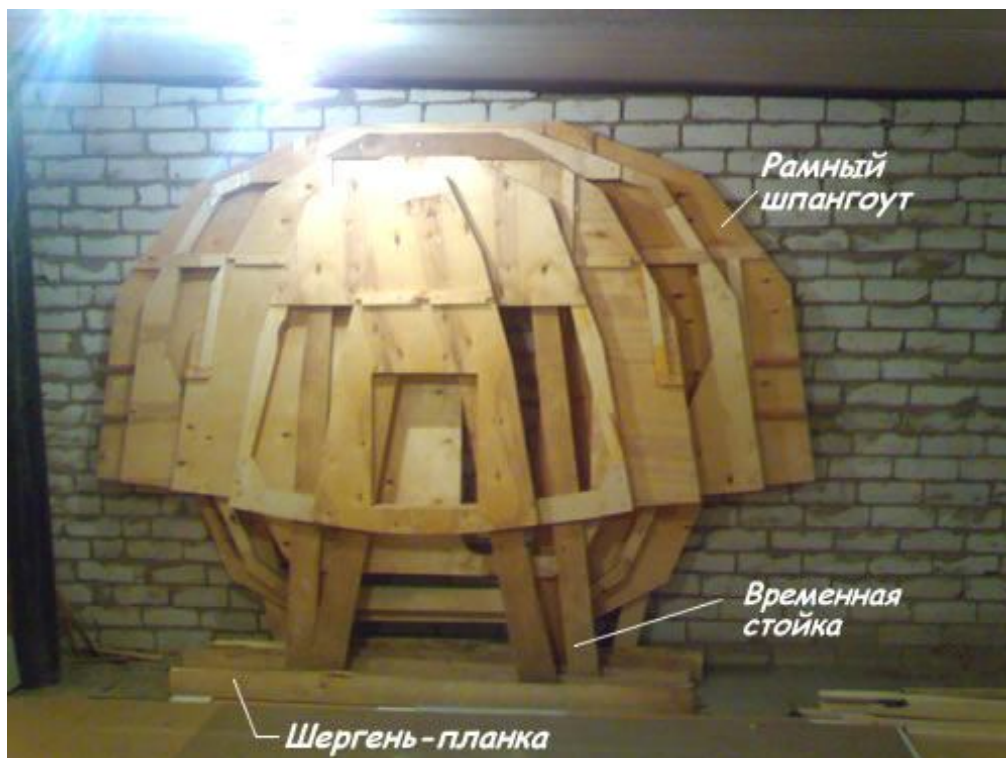
Рис 5. Готовая переборка на плазе с установленной шергень-планкой на уровне плоскости стапеля
