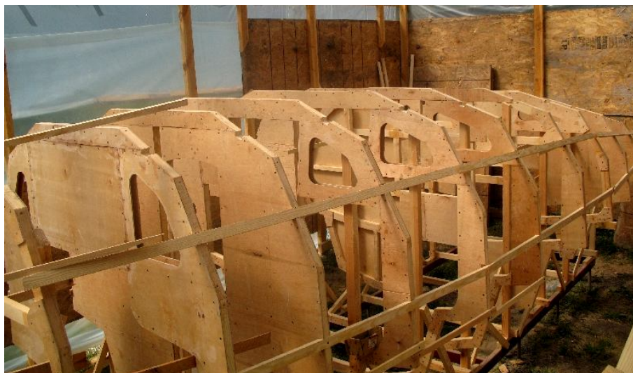
Поперечный набор судна (рамные шпангоуты и переборки) выставлен на стапель
