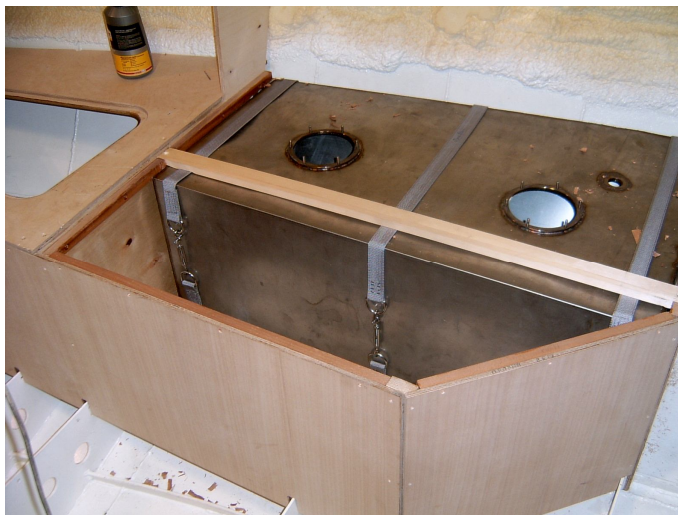
В данном случае строитель применил для крепежа танка текстильные лены, стянутые талрепами.
