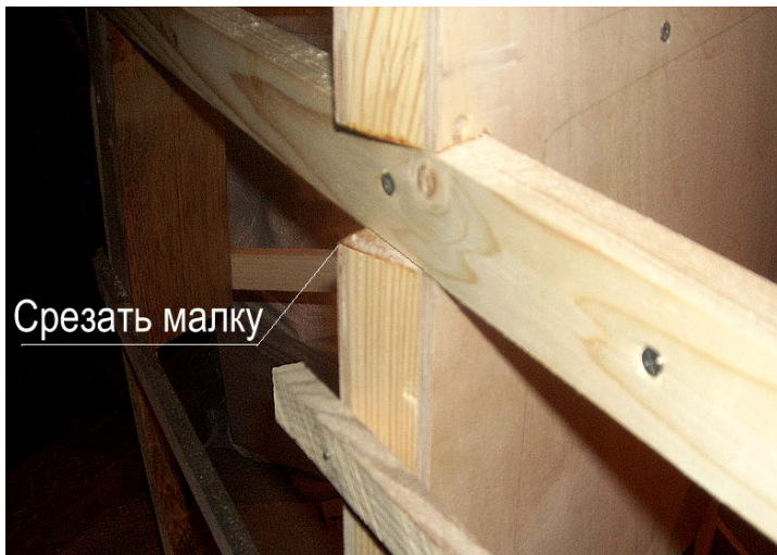
Рис 13. Врезка стрингеров и малковка набора.
