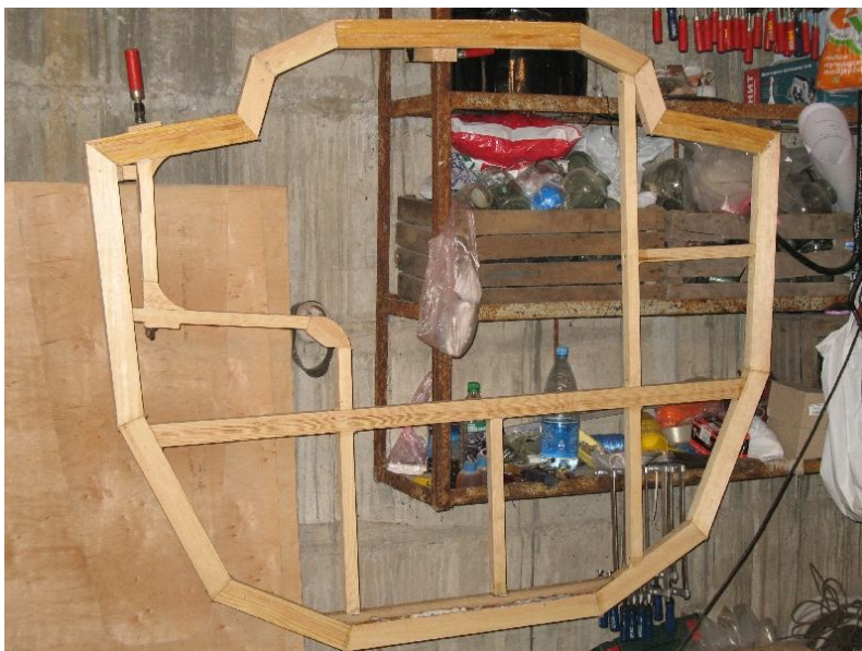
Рис. 4. Набор рамного шпангоута готов
