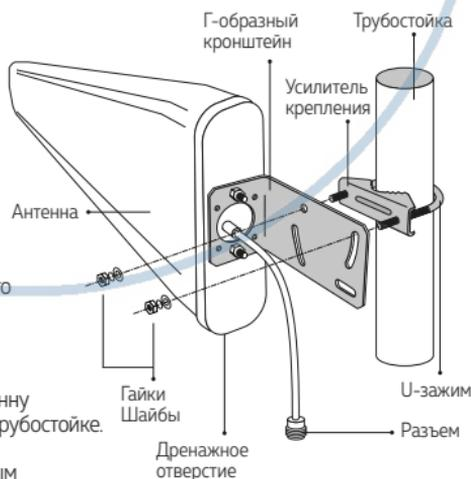
Антенна устанавливается дренажным отверстием вниз
