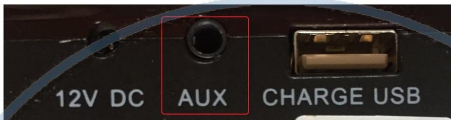
Кабель в комплекте. Подключите линейный выход с источника к входу изделия.
