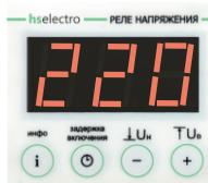
Если напряжение в сети не выходит за установленные пределы (180-250В по умолчанию), через 10 секунд прибор подключит нагрузку к сети, индикатор перестанет мигать. В дальнейшем при любом повышении или понижении уровня напряжения сети устройство отключит нагрузку, индикатор в мигающем режиме будет индицировать уровень напряжения в сети. Нагрузка не будет подключена до тех пор, пока напряжение не нормализуется.
