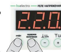
Устройство автоматически выйдет из режима калибровки через 10 секунд после последнего нажатия любой из кнопок.
