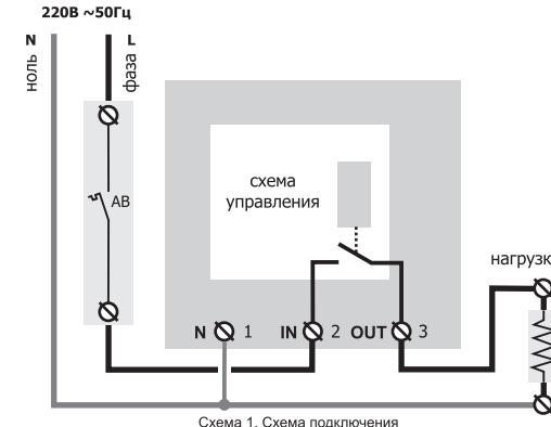
Суммарная мощность всех подключенных устройств не должна превышать максимальную мощность нагрузки прибора. Если мощности прибора недостаточно, необходимо использовать контактор.
