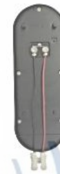
Нажмите и удерживайте один конец клеммной колодки и подсоедините провода к разъемам
