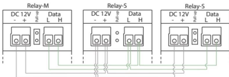
Для подачи питания на ведомое устройство соедините кабелем\*, соблюдая полярность, клеммы DC 12V блока Relay-4М и ведомого устройства.
