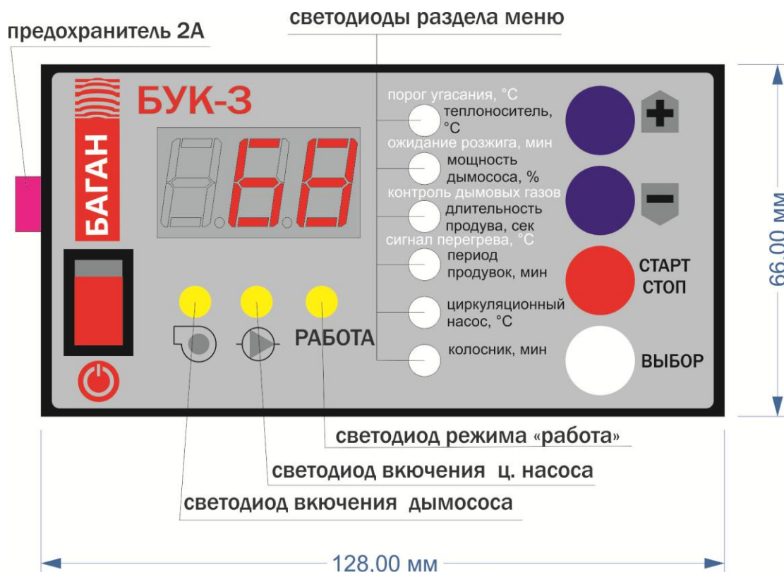
Рисунок 1. Устройство лицевой панели БУК-3
