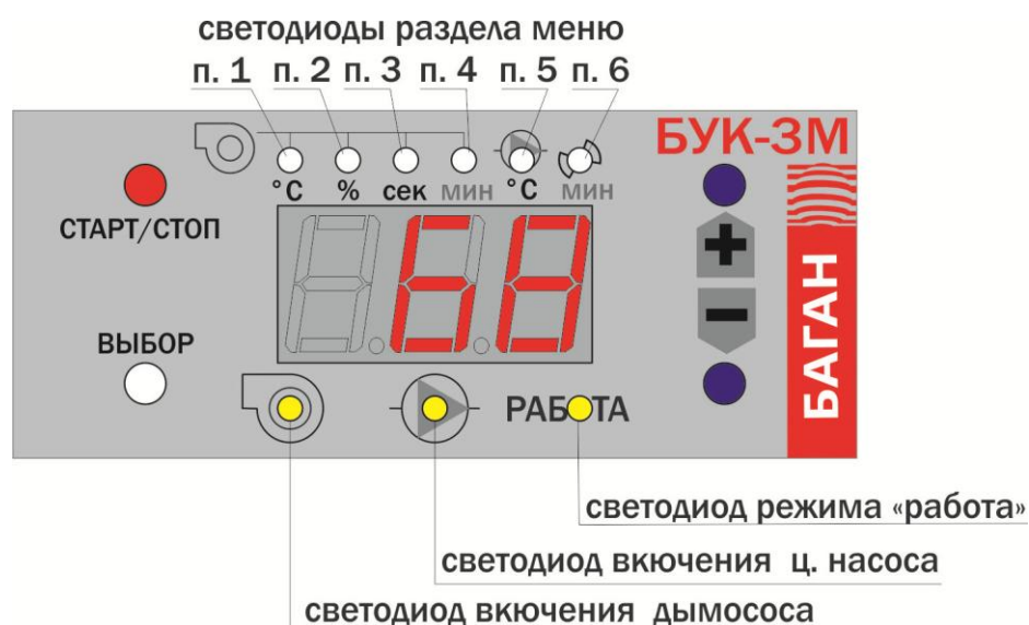
Рисунок 2. Устройство лицевой панели БУК-3М
