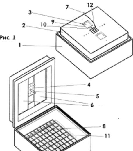
1 - корпус, 2 - крышка, 3 - смотровое окошко, 4 - терморегулятор, 5 - термодатчик, 6 - нагреватель, 7 - сетевой шнур, 8 - решётка для яиц, 9 - светодиод, 10 - ручка регулировки 11 - решетка-подложка 12 - дисплей
