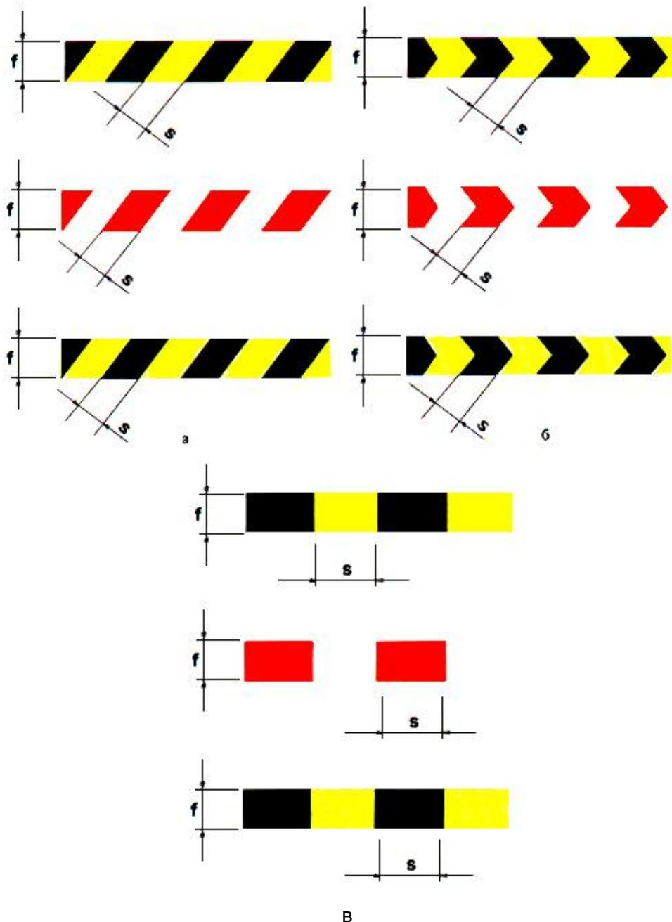
а - расположение полос наклонно; б - расположение полос зигзагообразно в виде "елочки"; в - расположение полос прямо (вертикально или горизонтально), f - поперечный размер сигнальной разметки, s - ширина полосы сигнального цвета.
