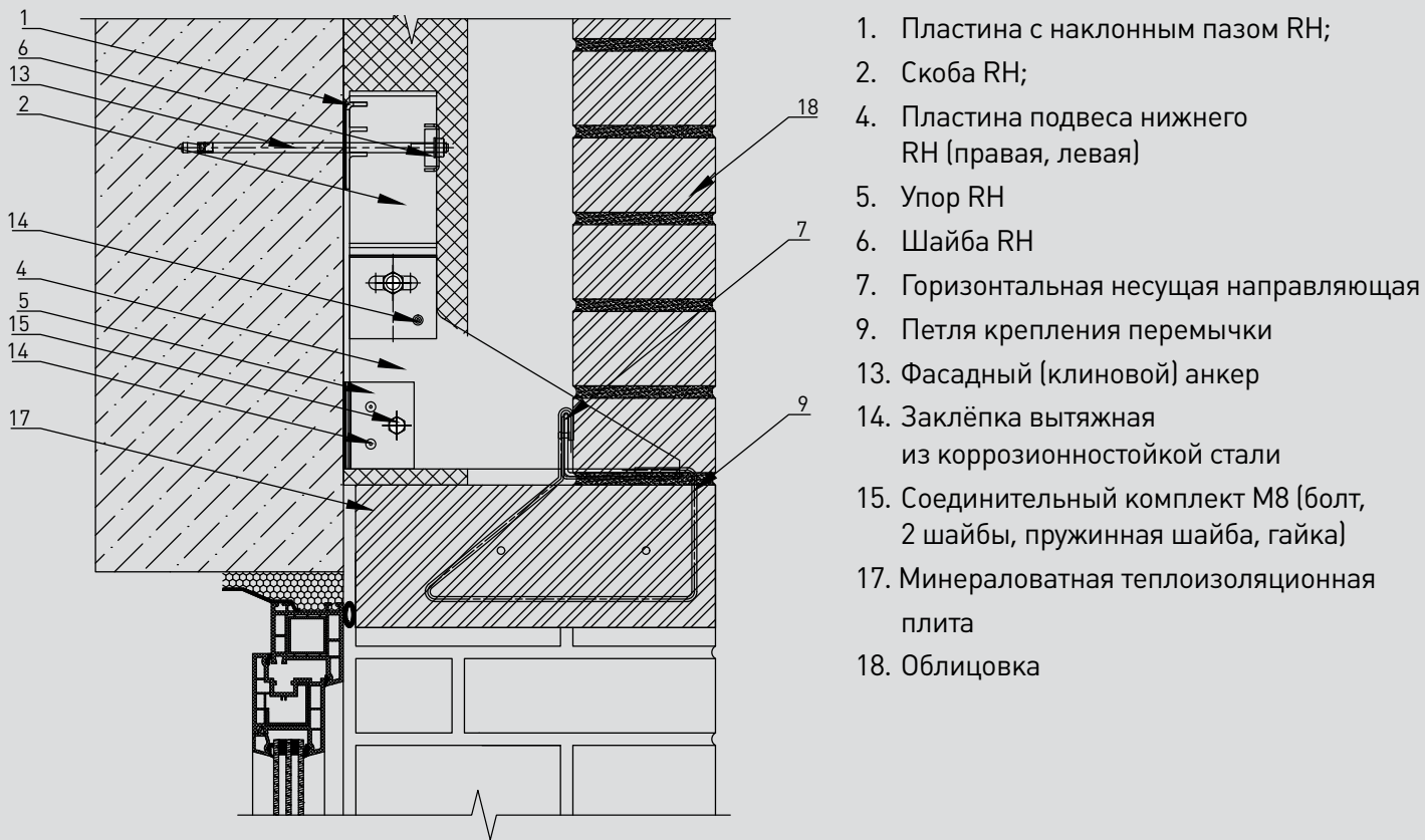
Примыкание к верхнему оконному откосу
