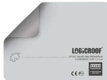
**Область применения:** ПВХ мембраны LOGICROOF применяются для гидроизоляции однослойных кровельных систем с механическим креплением и свариваются горячим воздухом при помощи автоматического оборудования. Мембраны сохраняют эластичность при низких температурах и применяются во всех климатических районах согласно СНиП 23-01-99. Запрещен прямой контакт со материалами, содержащими битум и растворители, а также с вспененными утеплителями (EPS, XPS, PIR, пеностекло).
