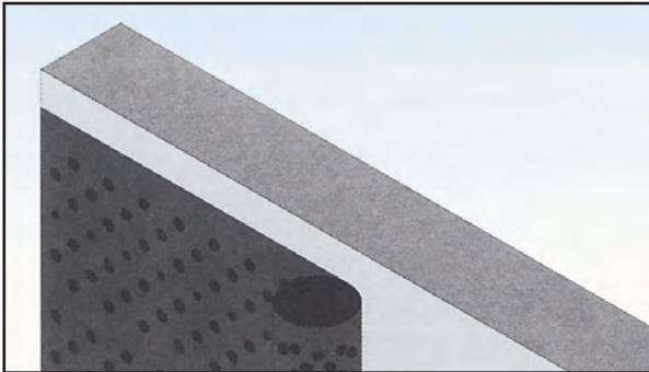
**2.** Необходимо убедиться, что опорные выступы, расположенные в центре замка, находятся внизу, после чего прикрепить покрытие к стене по верхнему краю покрытия при помощи гвоздей (с шагом 30 см). При этом необходимо использовать крепежные шайбы (см. рис. А и Б инструкции по вертикальной укладке).
