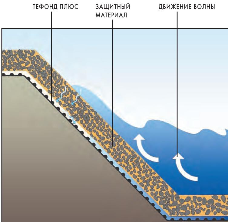
При определенных условиях водный поток может способствовать размыву основания защитных дамб и образованию протечек под ними. При высоком уровне воды поток из сифонного водосброса способен размыть основание перемычки со стороны нижнего бьефа и вызвать ослабление всей конструкции гидротехнического сооружения.
