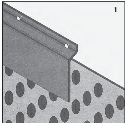
Отделочный профиль защищает воздушную камеру от проникновения грунта, воды и насекомых. Он крепится стальными дюбелями через имеющиеся в профиле отверстия, расположенные вдоль кромки профиля.
