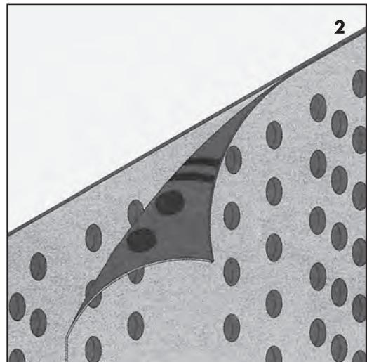
Двойной замок с нанесенным битумным герметиком гарантирует долговечную защиту от проникновения влаги между полотнами покрытия.
