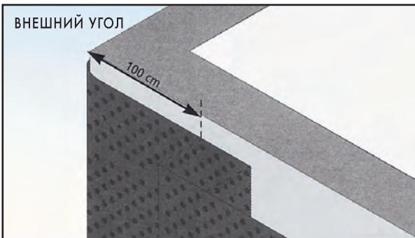
Полотна материала соединяются наложением их друг на друга на расстояние как минимум в 20 см, при этом выступы верхнего листа заходят в соответствующие гнезда нижнего. Шов соединения закрепляется нанесением на него самоклеящейся ленты ЭЛОТЕН.
