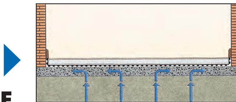
ТЕФОНД может укладываться непосредственно под любой пол, создавая при этом тепло- и звукоизоляцию (14 дБ) помещения, благодаря образуемому воздушному зазору и характеристикам материала.
