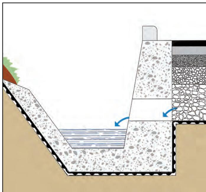
— ТЕФОНД «НР» служит распределителем нагрузки: он значительно уменьшает горизонтальные напряжения, возникающие на границах слоев дорожной одежды, снижая, таким образом, деформацию дорожного покрытия; при этом полностью снимаются напряжения на поверхности насыпи. Это означает, что по сравнению с традиционно устроенными покрытиями, возрастает значение допустимой нагрузки (до 46 % по результатам стендовых испытаний);
