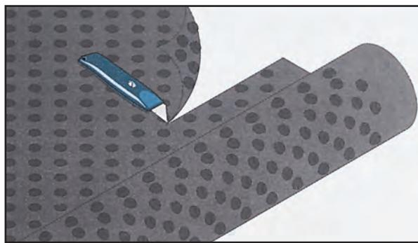
2. ТЕФОНД укладывается сверху вниз, слева направо. Начинать следует от края стены, или отступив 1 метр от любого угла (для того, чтобы впоследствии покрыть его целым листом).
