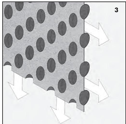
Воздушная камера, образующаяся при укладке ТЕФОНД ПЛЮС выступами к стене, позволяет воздуху циркулировать между стеной и покрытием, обеспечивая сухость поверхности.
