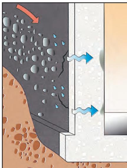
При обратной засыпке обычным грунтом и, что самое опасное, наличии в нем обломков скальных пород, происходит разрушение гидроизоляционного покрытия, что ведет к проникновению воды в подвальные помещения.
