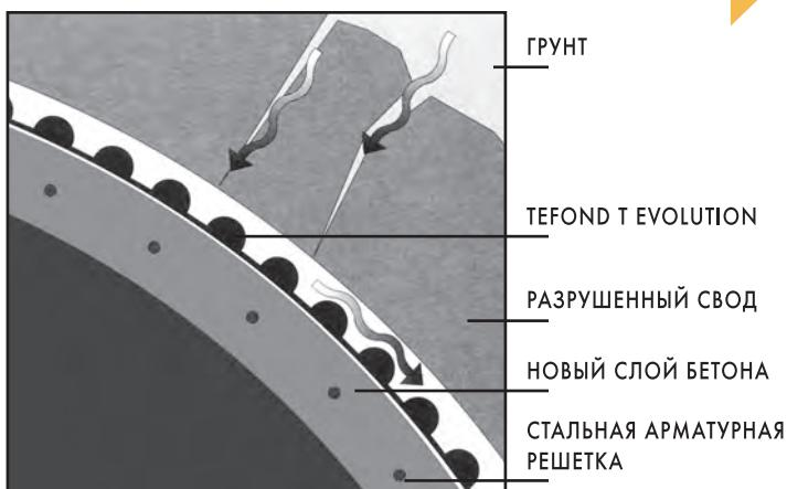
TEFOND T EVOLUTION можно крепить к предварительно залитому бетонному своду, скальным породам строящегося тоннеля или поверхности старого свода реконструируемого сооружения.
