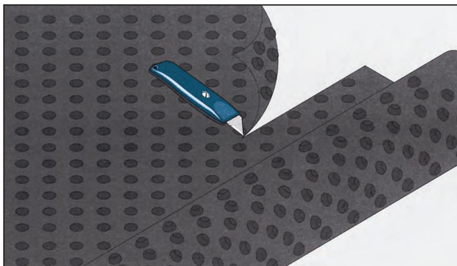
2. Соседние ряды покрытия крепятся друг к другу при помощи простого или двойного замка. Листы покрытия каждого ряда укладываются с нахлестом не менее 20 см. При этом шов соединения закрепляется с помощью ленты ЭЛОТЕН, которая наносится от ряда опорных выступов к наружной кромке полотна. Поперечные швы соседних рядов должны быть смещены относительно друг друга по меньшей мере на 50 см.
