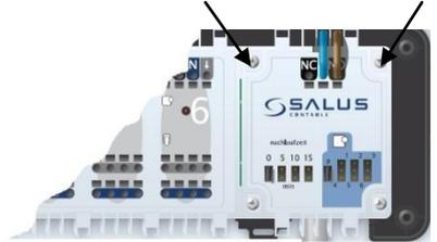
С помощью первого переключателя Вы можете определить время работы насоса. Это время, в течение которого насос будет работать после закрытия всех сервомоторов. Существует возможность выбора 0, 5, 10 и 15 минут. Когда функция работы насоса активна, на модуле PL06 начинает гореть красный светодиод и горит, пока не истечет определенное раньше время работы насоса.
