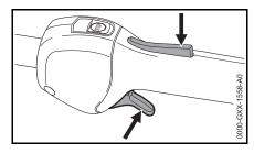
Нажать фиксатор рычага акселератора и дать газ – рычаг воздушной заслонки перескакивает в рабочее положение I – после запуска в холодном состоянии прогреть двигатель, несколько раз изменяя нагрузку
