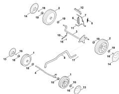
Механизм для перемещения, регулирования по высоте
