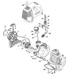
Пусковое устройство, Топливный бак
