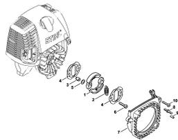
Муфта, Корпус вентилятора
