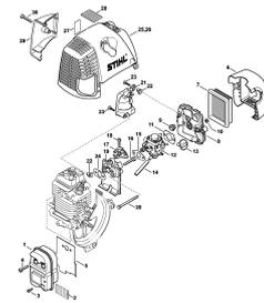
Шумоглушитель - Воздушный фильтр, Кожух воздухопровода
