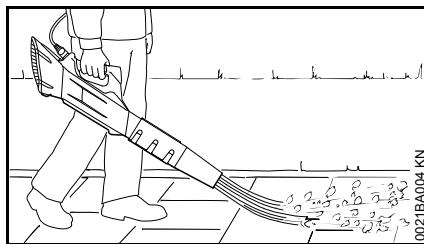
Воздуходувное устройство сконструировано для управления одной рукой. Оно может переноситься оператором за рукоятку управления в правой или левой руке.
