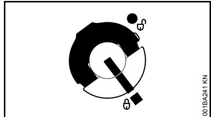
Крышка бака зафиксирована
