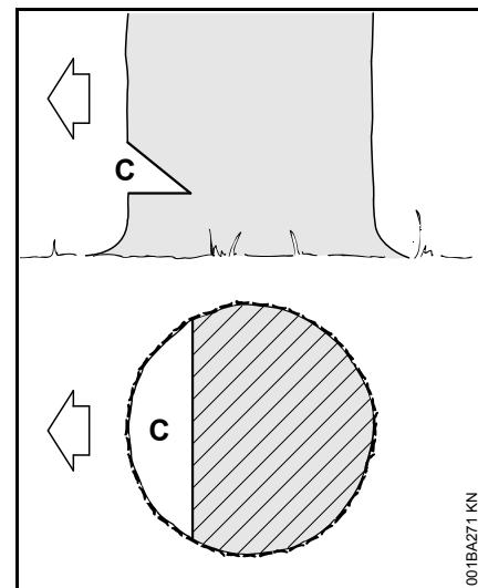
Подпил (С) определяет направление валки дерева.
