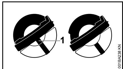
слева: Нижняя часть крышки бака перекручена – расположенная внутри маркировка (1) совпадает со внешней маркировкой
