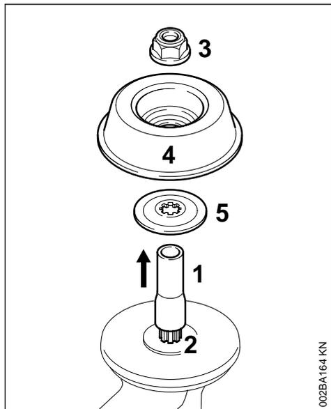
Для этого в зависимости от исполнения режущего инструмента дополнительно необходима гайка (3), подвижный диск (4) и упорная шайба (5).
