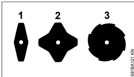
На режущих дисках для травы (1) и (2) режущие кромки могут быть направлены в любую сторону – этот режущий инструмент регулярно поворачивать, чтобы избежать одно-стороннего износа.
