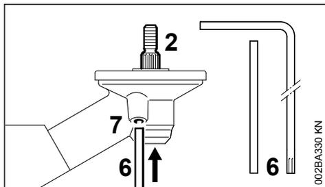
Для монтажа и демонтажа режущих инструментов вал (2) необходимо заблокировать с помощью дорна (6) или изогнутой отвертки (6). Инструменты входят в объем поставки, а также поставляются в качестве специальных принадлежностей.
