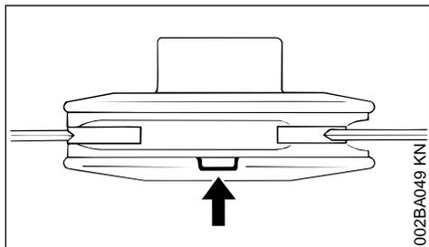
Если на косильной головке PolyCut одна из маркировок нарушена в направлении вниз (стрелка): косильную головку больше не применять и заменить новой! **Опасность получения травмы** отбрасываемыми обломками поломанного инструмента!
