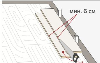
Чтобы отрегулировать ширину последнего ряда досок, поместите последнюю доску поверх предпоследней. Отметьте контур стены на последней доске, используя другую в качестве направляющей, и распишите её соответственно.
