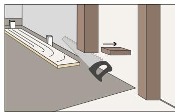
Укладка под дверные рамы. Поместите одну планку FAUS на пенополиэтилен, касаясь дверной рамы, и разрежьте раму на этой высоте. Всегда помните, что нужно оставить место для расширительного зазора.
