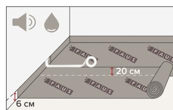
Поместите подложку FAUS, сделанную из пенополиэтилена lm+, покрывающую всю площадь. Убедитесь, что конец одного куска и начало нового перекрывают друг друга не менее чем на 20 см, а края покрывают до 6 см окружности стены. Заделайте стыки скотчем. Подложка, в дополнение к своей функции выравнивания, уменьшает акустические вибрации, вызванные шагами и стуком.
