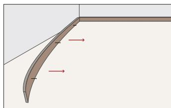
Снимите все плинтусы для правильной установки и оставьте компенсационный зазор между стеной и ламинатом, равный 10-12 мм.
