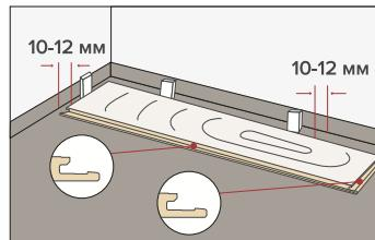
Крайне важно оставлять компенсационные зазоры между напольным покрытием и стеной или другим стационарным покрытием. Не укладывать пол вплотную к какой-либо фиксированной точке в комнате.
