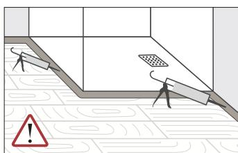
В помещениях с повышенной вероятностью контакта с водой необходимо заполнить расширительные зазоры герметиком. Всегда используйте силиконовые уплотнители в дверных проёмах ванной комнаты, чтобы отделить пол ванной комнаты от остальной части пола.
