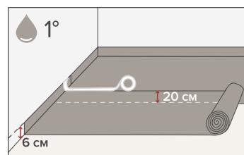
Основание пола всегда должно быть покрыто полиэтиленовой пленкой толщиной не менее 2 мкм в качестве пароизоляции. Всегда помните, что бетонные основания пола должны быть уложены не менее чем за месяц до начала укладки вашего пола FAUS. Тем не менее, в случае очень влажных полов всегда лучше обратиться к нашему дистрибутору за техническими инструкциями.
