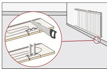
При укладке досок вокруг труб просверлите отверстие размером на 2 см больше, чем рассматриваемая труба, для целей расширения. Отрежьте планку по диагонали относительно центра отверстий.
