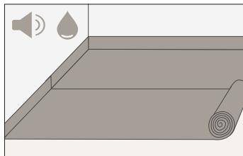
Обязательно и крайне важно использовать полиэтиленовую плёнку при укладке ламинированного напольного покрытия. Её применение обязательно при укладке на любой вид основания.
