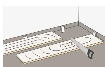
Отметьте и вырежьте последнюю доску, причём декоративная поверхность должна быть направлена вверх, если используется ручная пила, и вниз, если используется электрическая пила.
