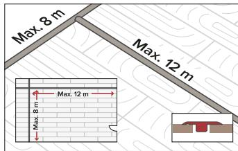
Для поверхностей площадью более 100 м<sup>2</sup>, длиной 12 м и шириной 8 м потребуется дополнительный расширительный зазор, который закрывается Т-образным порожком.
