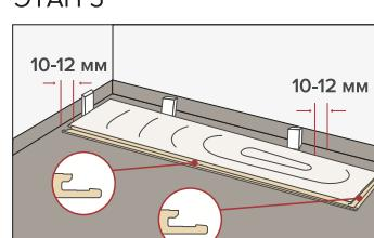
Начните с левого угла. Поместите первую планку к стене и вставьте монтажные клинья между стеной и планкой. Мы рекомендуем вам отрезать часть, выступающую из планки, чтобы избежать проблем с зазорами расширения.
