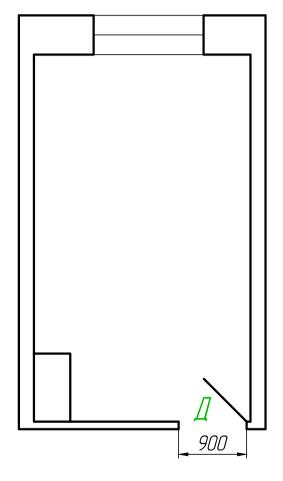
Д дверной проем ширина 900 мм, высота 2070 мм дверное полотно ширина 800 мм, высота 2000 мм 0.000 чистый пол
