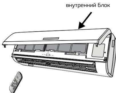
2. Регулирование направления потока воздуха в вертикальной плоскости (вверх-вниз). Регулирование направления потока воздуха в вертикальной плоскости выполняется поворотом горизонтальных жалюзи с пульта дистанционного управления с помощью клавиши SWING.
