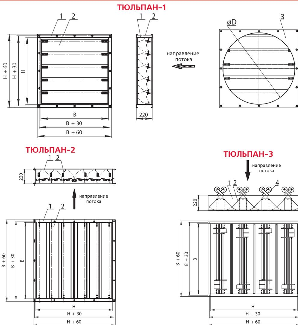
1 – корпус 2 – лопатка 3 – переходник 4 – противовес.
