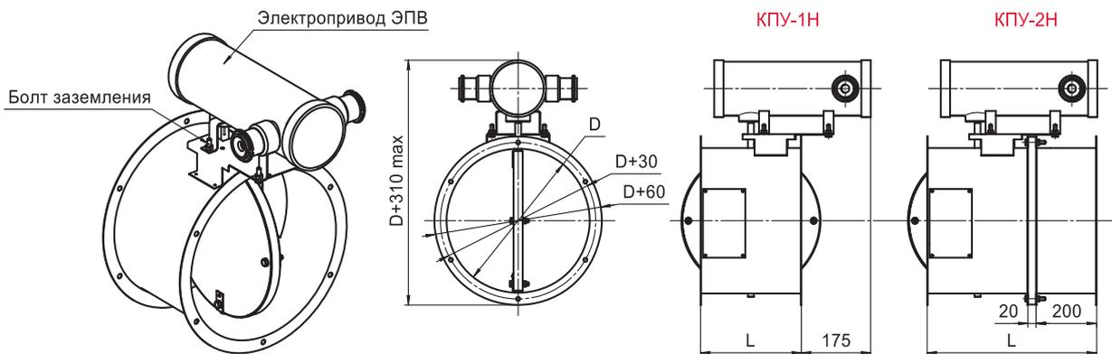
**Клапан серии КПУ®-3 взрывозащищенный канального типа**
