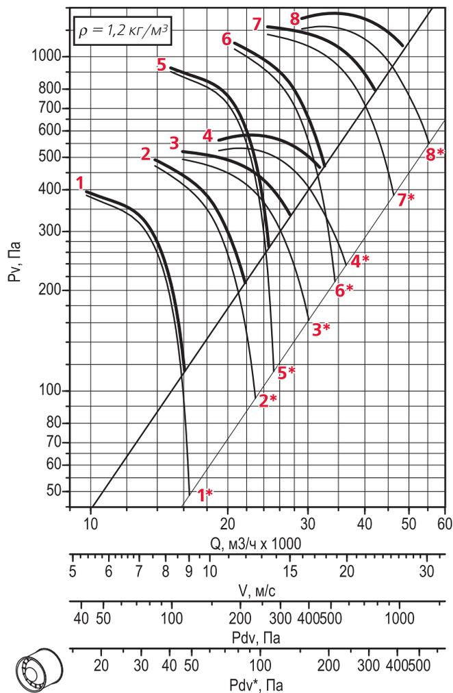
\* — характеристики вентилятора с выходным каналом (компоновка 02, 04)
