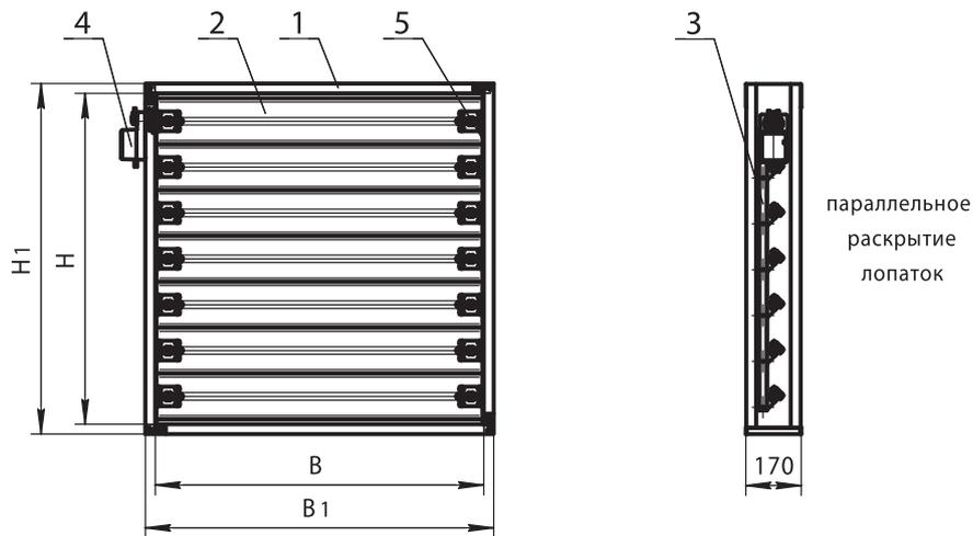
1 – корпус; 2 – лопатка; 3 – тяга; 4 – исполнительный механизм; 5 – пружинное уплотнение.
