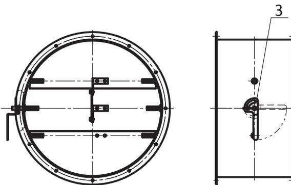
1 – корпус; 2 – лопатка; 3 – исполнительный механизм.
