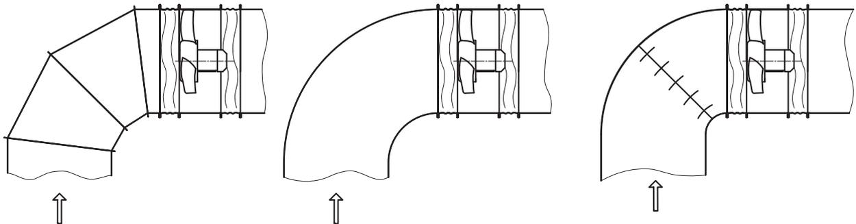
При необходимости установки поворотных участков сети непосредственно вблизи вентилятора рекомендуется использовать составное колено или поворотный участок с большим радиусом закругления, или поворотный участок с расположенной в нем системой лопаток.
