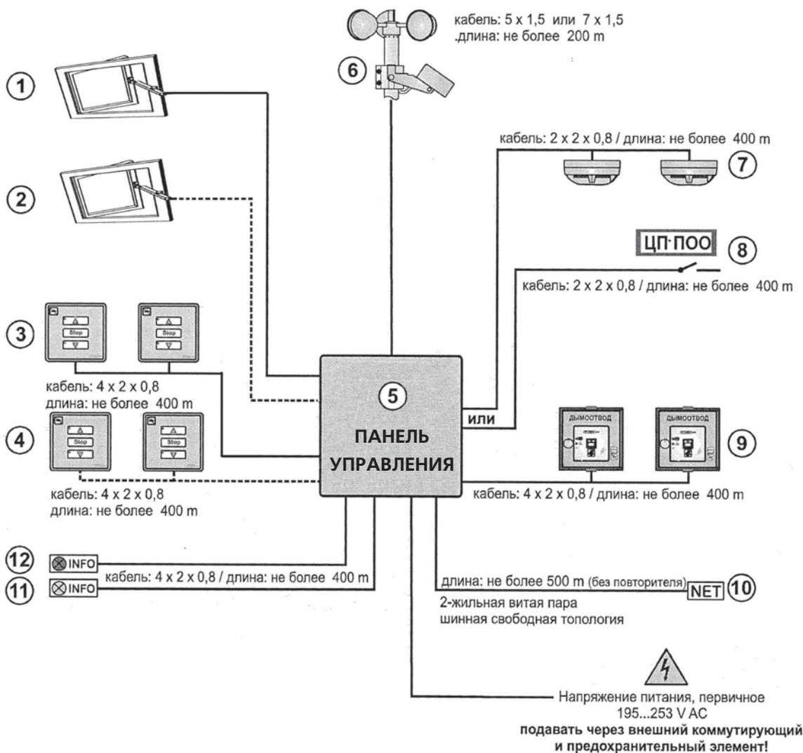
**Условные обозначения схемы подключения возможных устройств**
