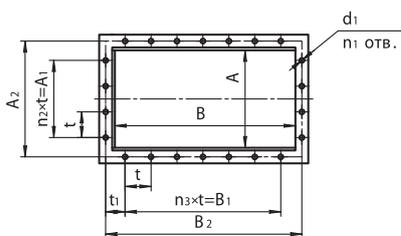
Расположение отверстий крепления вентиляторов
