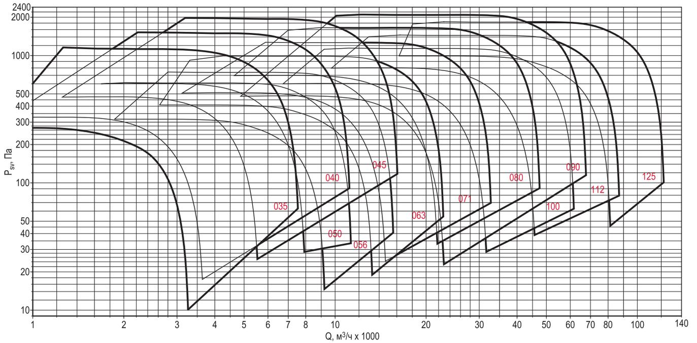
**КРОС-ДУВ-Ф вентилятор с использованием ЧРП**
