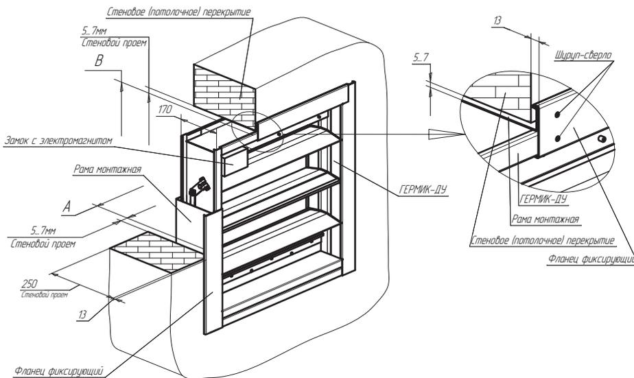
**Схема присоединения к шахте клапана ГЕРМИК®-ДУ канального типа**
