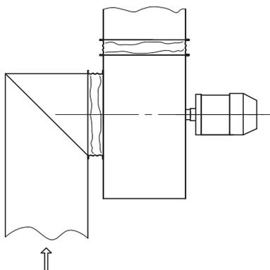
Не рекомендуется использовать простое колено непосредственно перед и за вентилятором. Установка такого поворотного участка приводит к значительному снижению производительности вентилятора и увеличению создаваемого шума.
