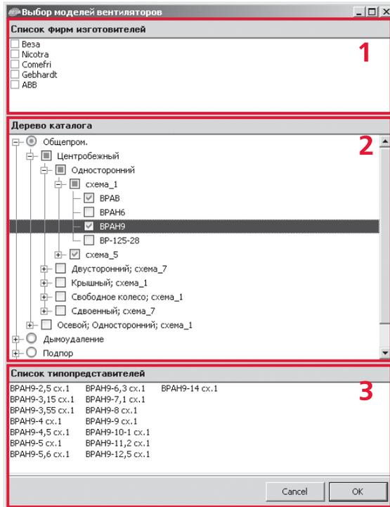
**2. Номенклатурная панель** (рис. 2) состоит из трех элементов управления: 1 – список-фильтр фирм – производителей, 2 – дерево типов вентиляторов и 3 – список типопредставителей выбранного типа вентиляторов. Список-фильтр позволяет ограничить содержимое номенклатурной панели вентиляторами определенных фирм-производителей.
