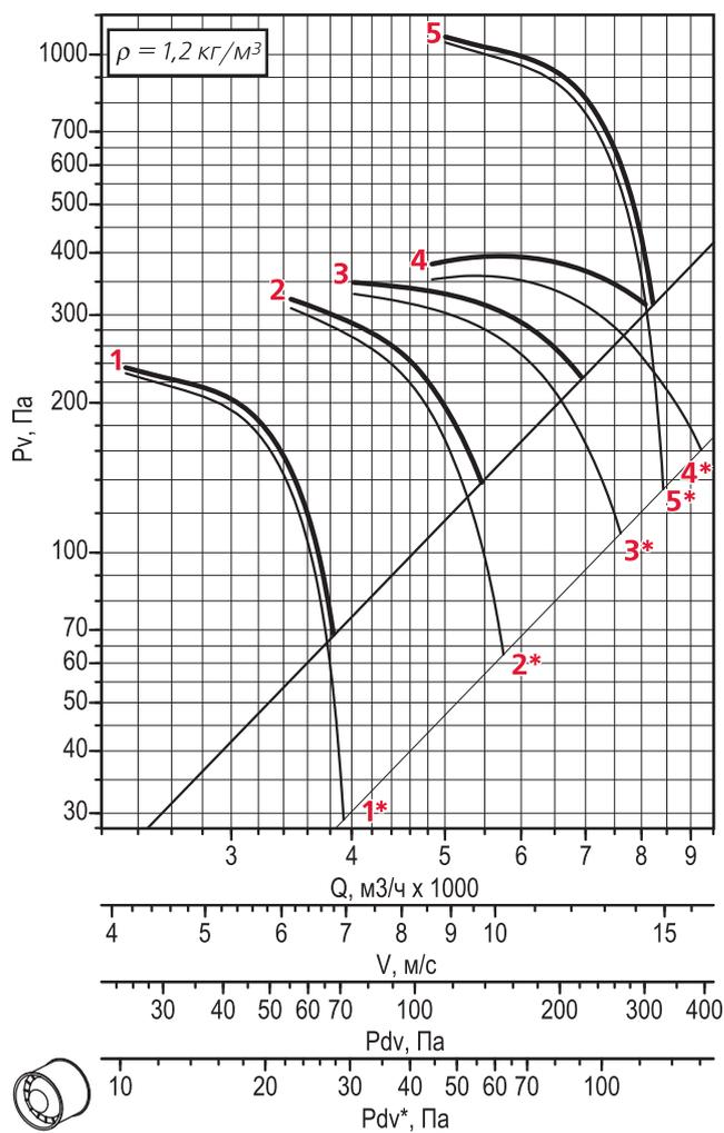
\* — характеристики вентилятора с выходным каналом (компоновка 02, 04)
