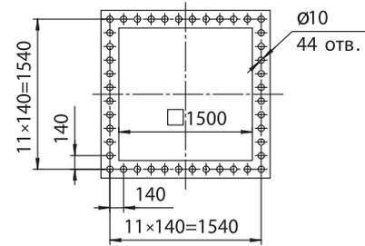
**Выходной фланец вентиляторов**
