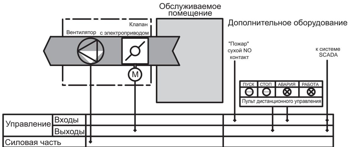
**ШСАУ-ВДУ/ШСАУ-ВПД прямой пуск двигателя вентилятора**
