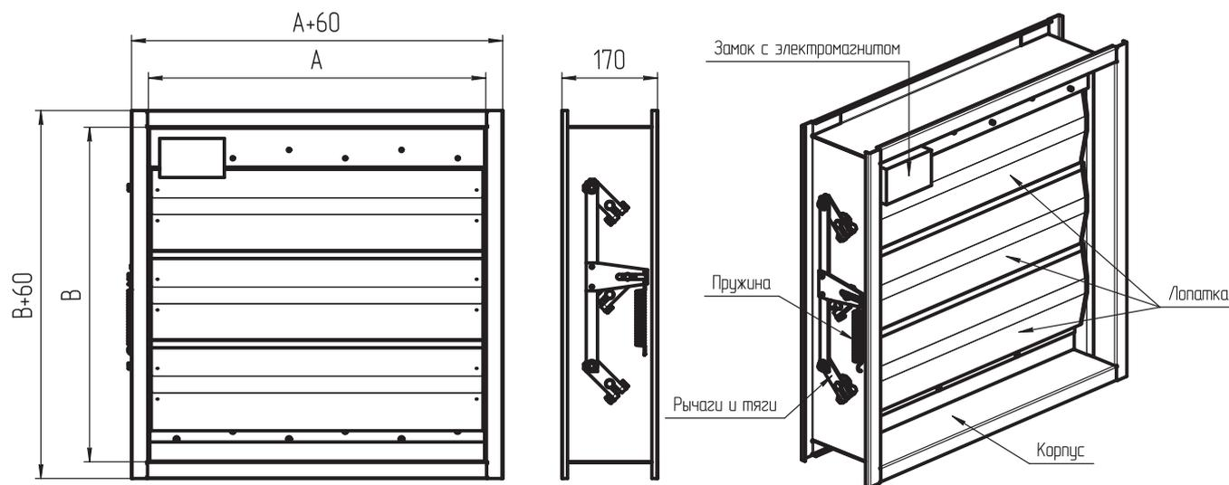
**ГЕРМИК-ДУ стенового типа с электроприводом**
