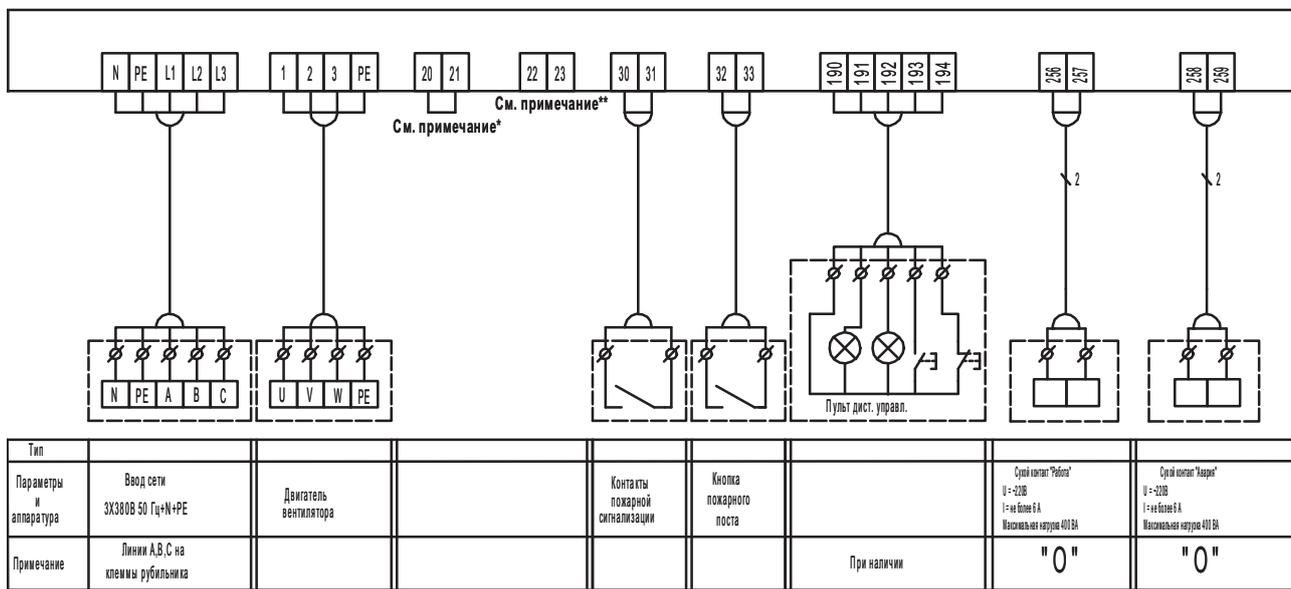
**ШСАУ-ВДУ с частотным преобразователем**
