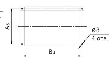
**Расположение отверстий крепления вентиляторов**
