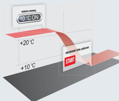
Если температура в помещении превышает +10 °C, режим не активируется. Если температура опускается ниже +10 °C, сплит-система начинает работу в режиме обогрева.
