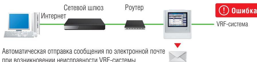
Автоматическая отправка сообщения по электронной почте при возникновении неисправности VRF-системы.
