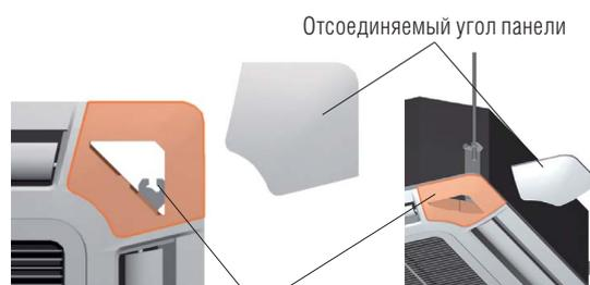
Можно быстро отрегулировать, отсоединив угол панели
