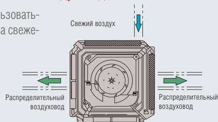
К кассетному блоку можно подсоединить гибкие воздуховоды для обеспечения удаленного распределения обработанного воздуха.
