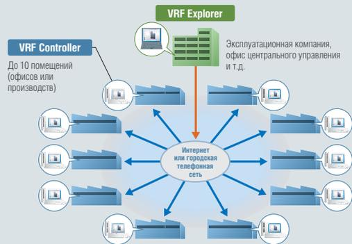
Один VRF Controller может контролироваться любым количеством программ VRF Explorer (до 5 одновременных соединений).
