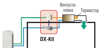
При подсоединении к теплообменнику системы вентиляции VRF-системы Fujitsu датчик контролирует температуру подаваемого воздуха.
