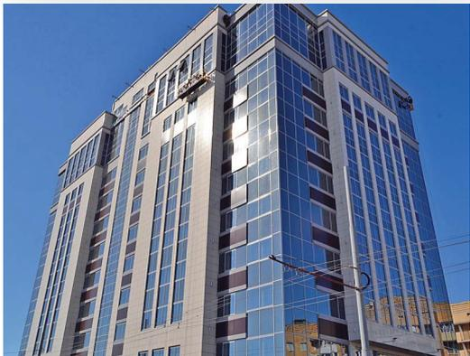
В 2015 году завершилось строительство 11-этажного здания Арбитражного суда Оренбургской области. Для обеспечения комфортного микроклимата была выбрана мультizonальная система Fujitsu серии V-II. На объекте установлено 35 наружных и 384 внутренних блока кассетного и канального типов. Суммарная мощность оборудования составляет 1265 кВт.
