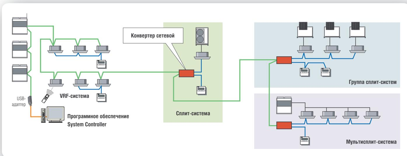
Примечание. Не все сплит-системы Fujitsu могут быть подключены к VRF-системе. За подробной информацией о совместимости обращайтесь в службу технической поддержки Fujitsu. Одна VRF-система может включать в себя до 100 сетевых конвертеров. Каждый сетевой конвертер рассматривается в качестве отдельной системы кондиционирования независимо от количества подсоединенных блоков.
