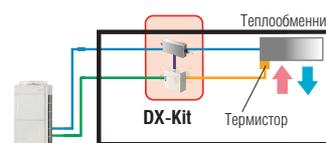
В случае подключения теплообменника температура в помещении регулируется с помощью датчика по температуре входящего воздушного потока.
