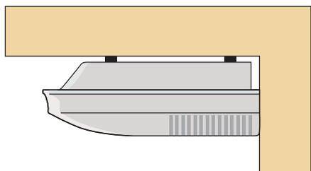
Стандартный способ монтажа, при котором внутренний блок закрепляется на поверхности потолка.
