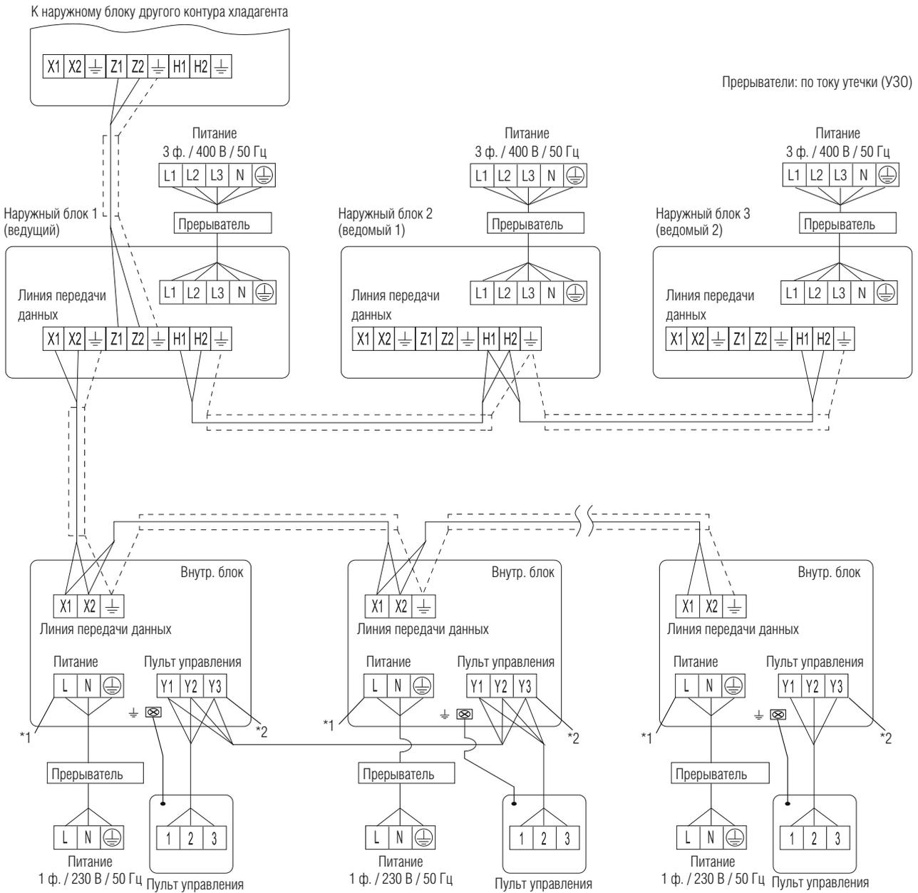
\*1 Число контактов электропитания может отличаться в зависимости от модели внутреннего блока. Электроподключение внутреннего блока описано в руководстве по установке.
