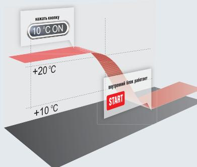
Если температура в помещении превышает +10 °С, режим не активируется. Если температура опускается ниже +10 °С, сплит-система начинает работу в режиме обогрева.
