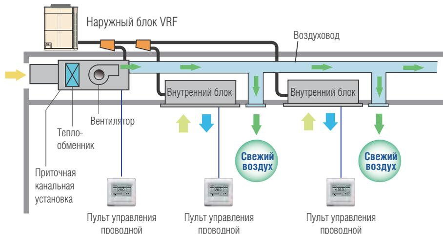
Прямоточные каналные блоки с фреоновым теплообменником подключаются к наружному блоку VRF-системы.
