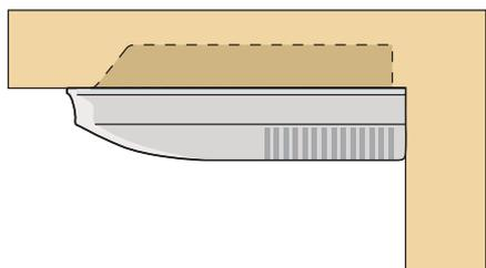
При этом способе монтажа часть внутреннего блока встраивается в потолочную конструкцию.
