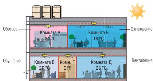
Благодаря функции автоматического переключения внутренние блоки в одном помещении легко переключаются между режимами охлаждения и обогрева независимо от режима работы блоков в других помещениях. Функция активируется с проводного пульта управления.
