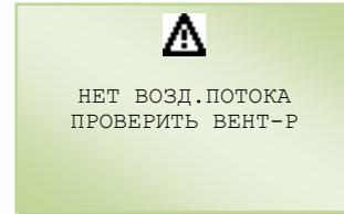
Подается дифференциальным сенсором повышенного давления потока воздуха (FSA). Вызывает выключение всех устройств (компрессоров, электрических сопротивлений, увлажнителя, вентиляторов).
