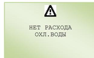
Только для кондиционера CW (только сигнализация). Подается сенсором температуры охлажденной воды, если заданное установочное значение не достигается в течение 15 минут с момента начала осушения.
