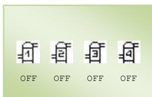
В моделях CW и CW Dual Coil показываемая маска указывает количество клапанов холодной воды, состояние открытия и температуру воды на входе и выходе.
