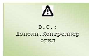
Включается, когда управление автоматически не определяет частоту электрической сети.
