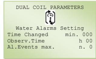
Этот экран показывается только, если кондиционер оснащен электрическими сопротивлениями ('ELECTRIC REHEAT' > 0) и батареей с горячей водой ('HOT WATER COIL Si').
