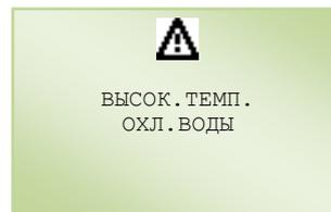
Только для кондиционера TC. Вызывает переключение работы от охлажденной воды (CW) на прямое расширение (DX). Отображается и в том случае, когда датчик температуры помещения в первый раз определяет превышение заданного уровня.
