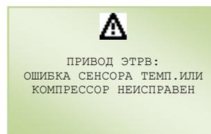
Активна вследствие ошибки в сигнале, идущем от сенсора температуры NTC низкого давления из-за перегрева. Также указывает номер контура.
