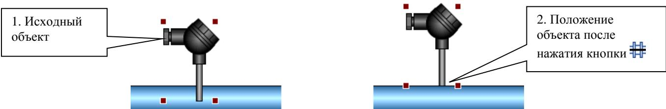
2. Кнопка (или команда *Выровнять > Установить размер объекта по диаметру трубы* в контекстном меню) позволяет установить размер объектов в соответствии с диаметром трубы, на которой находятся объекты. Рисунок ниже иллюстрирует действие кнопки .
