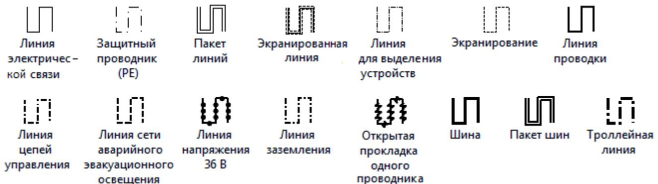
Толщина, штриховка, цвет линии задаются в диалоговом окне [Линии](#). Для некоторых линий недоступно менять толщину и(или) штриховку (например, для шины, пакета шин, для линий проводки и др. элементов, относящихся к ГОСТ 21.210), для некоторых - только штриховку (например, для экранированных линий и др. элементов, относящихся к ГОСТ 2.721-74).
