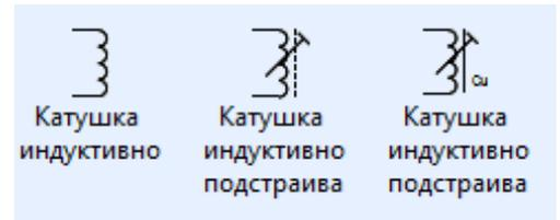
Начало обмотки, магнитопровод возможно добавить на схему как отдельные объекты. Иконки для вставки этих и других элементов содержатся в подразделе *Элементы катушек индуктивности, дросселей, трансформаторов, автотрансформаторов и магнитных усилителей* раздела *Индуктивность*.
