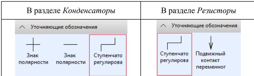
После вставки объекта на схему, для него становится доступен ввод [текста](#) для указания числа ступеней. Например,
