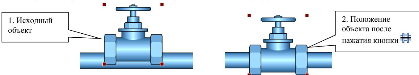
Некоторые объекты (например, манометр или датчик температуры) можно привязать к трубе, но не к центральной оси, а к границе трубы. Для этого предназначена та же самая кнопка . Рисунок ниже иллюстрирует действие кнопки.
