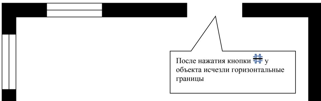
Дверь 2, 3, 4, 5, 6 привязывается не к центральной оси сегмента стены, а к верхней границе сегмента (чтобы привязать ее к нижней границе сегмента, нужно повернуть объект на 180°). После привязки двери будет закрашен цветом фона участок стены за дверью. Например,
