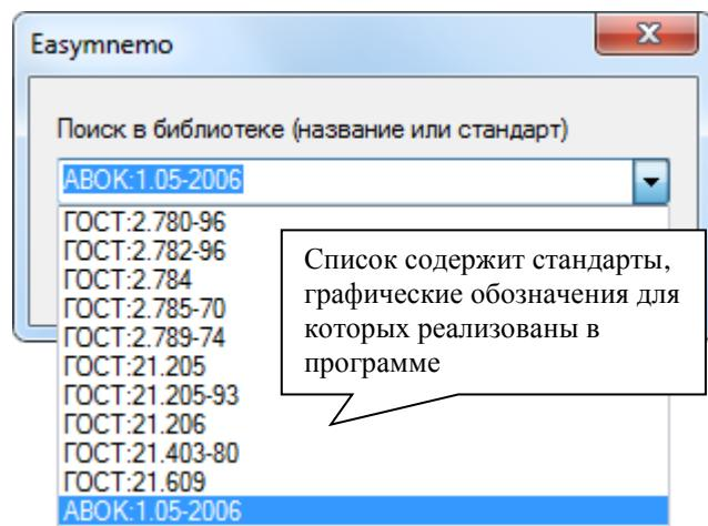
В этом примере на *Панели элементов* появятся элементы, условные графические обозначения которых установлены стандартом АВОК:1.05-2006.
