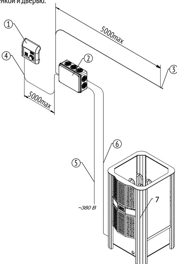
**Рис. 3 Общий вид подключения электрокаменки к пульту управления:**
