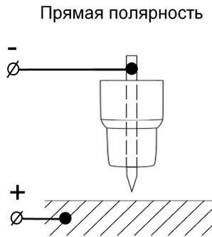
Рис. 8.6. Полярность при TIG сварке.
