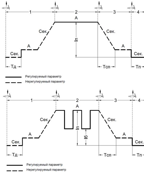
Рис. 7.4. Режим работы аппарата 4Т и 4Т Р.
