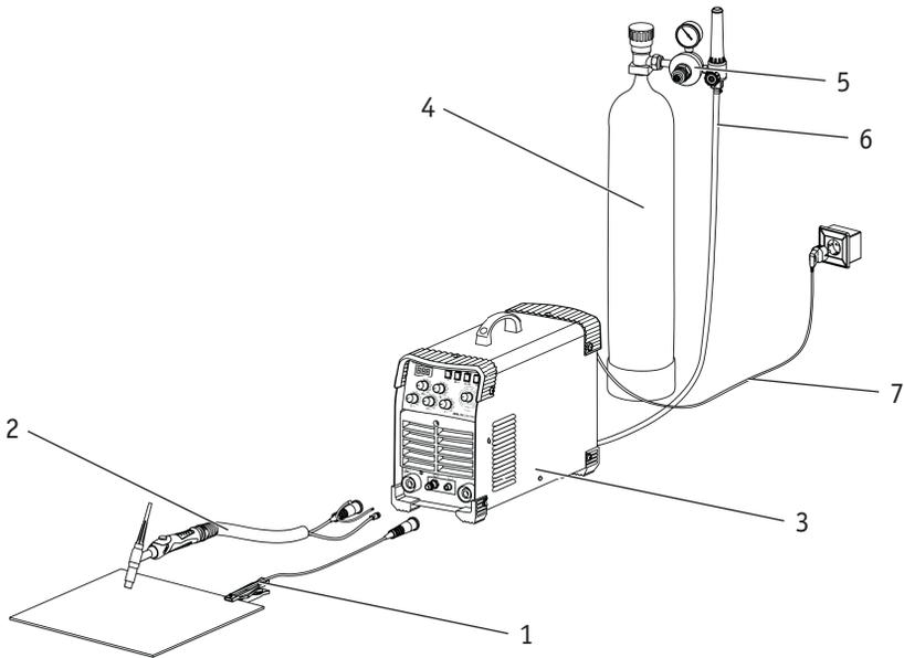
Рис. 8.1. Схема подключения оборудования REAL TIG 200 P AC/DC (E20101).
