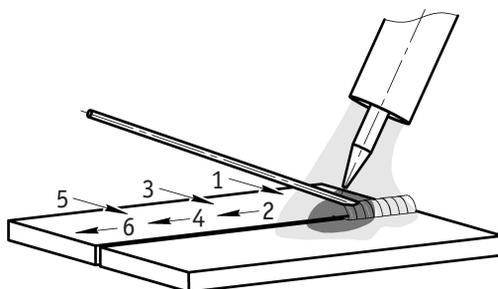
Рис. 8.17. Пример манипуляции присадочной проволокой при TIG сварке.
