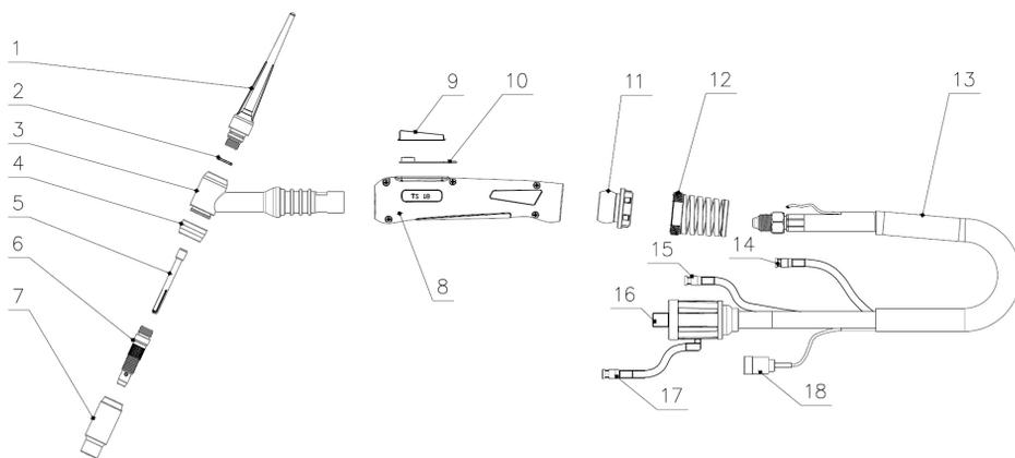
Рис. 8.9. Горелка для аргодуговой сварки с водяным охлаждением.
