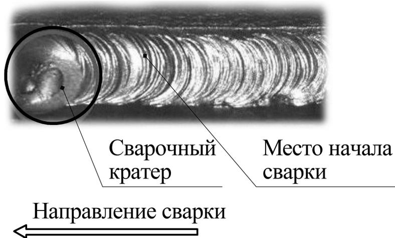
Рис. 9.4. Начало сварки при смене электрода.
