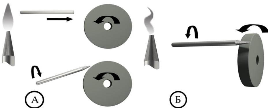
Рис. 8.14. Пример заточки вольфрамового электрода:
