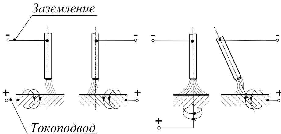
Рис. 9.5. Схема отклонения дуги постоянного тока.
