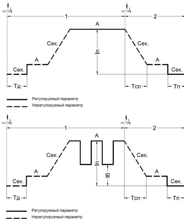
Рис. 7.3. Режим работы аппарата 2Т и 2Т Р.
