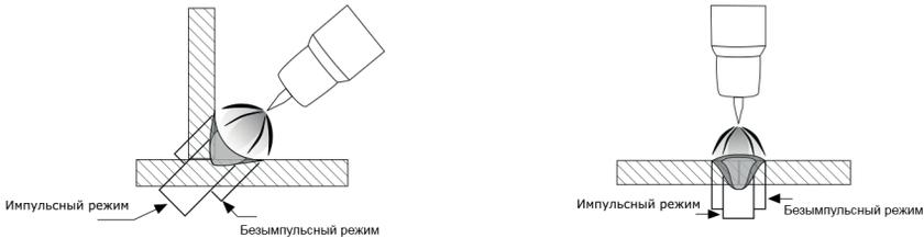
Рис. 8.10. Выделяемое тепло в импульсном и безимпульсном режимах.
