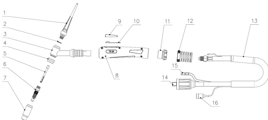
Рис. 8.8. Горелка для аргодуговой сварки с воздушным охлаждением.
