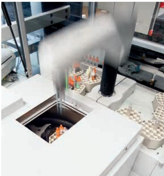
Роботизированные центрифуги используются в случаях, когда работа с образцами может быть автоматизирована, что способствует существенной рационализации и безопасности выполнению рутинных процессов, которые могут быть связаны с огромным количеством практических задач.
