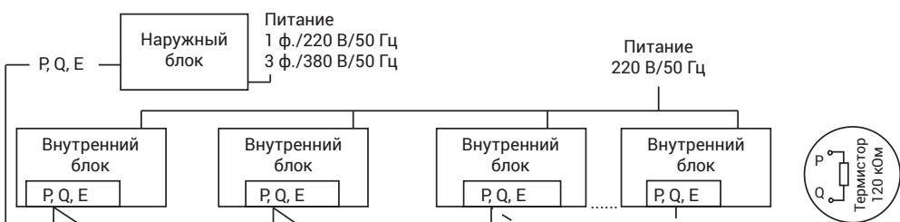
Подключение линии связи к 2-трубным системам LMV-Mini
