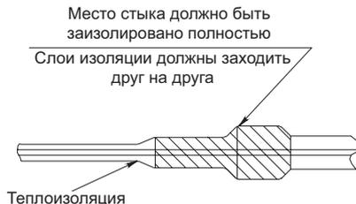
Теплоизоляцию закрепите монтажным скотчем.
