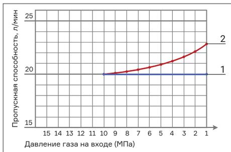
Линия 1 – это 2-х ступенчатые регуляторы расхода газа со встроенным экономайзером при непрерывной работе. Давление в баллоне снижается с 11 МПа до 1 МПа за 195 минут.
