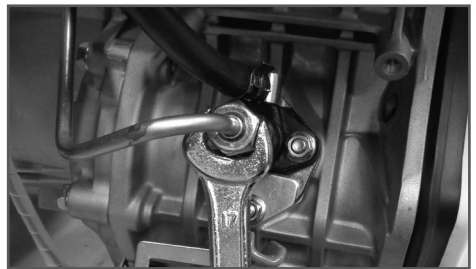
Рис. 12 Удаление воздуха из топливного насоса
