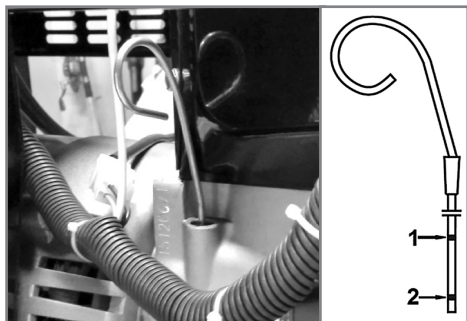
Рис. 8 Проверка уровня масла в картере
