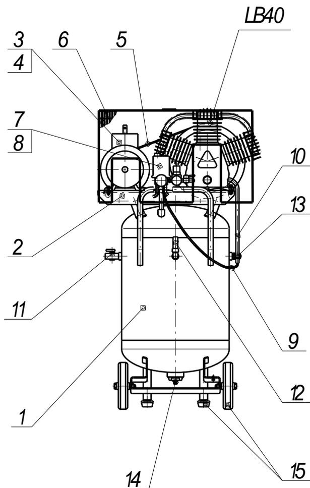
Рисунок 3 – Общий вид компрессора СБ4/С-100.LB40В
