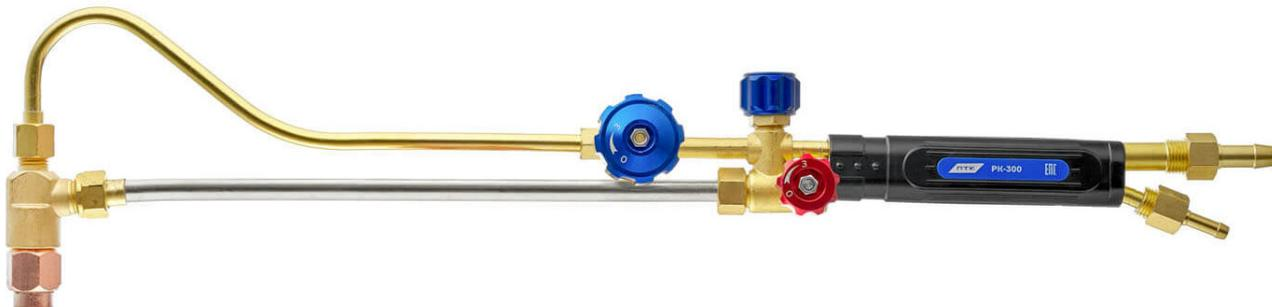
Резак жидкотопливный керосиновый РК-300 предназначен для ручной разделительной резки низкоуглеродистых сталей толщиной до 200 мм. В качестве горючего используется керосин осветительный по ОСТ 38.01407-86 или топлива ТС-1 по ГОСТ 320.001.499.43.011-99.
