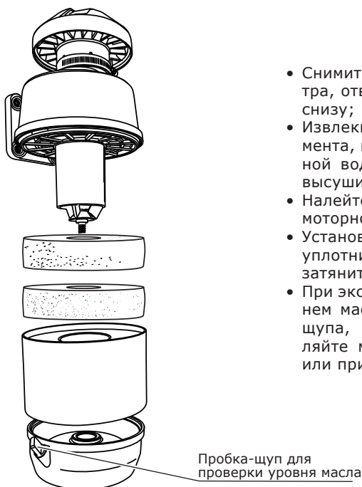
Рис. 18. Обслуживание воздушного фильтра генераторов УГД-10500Е и УГД-10500ЕТ
