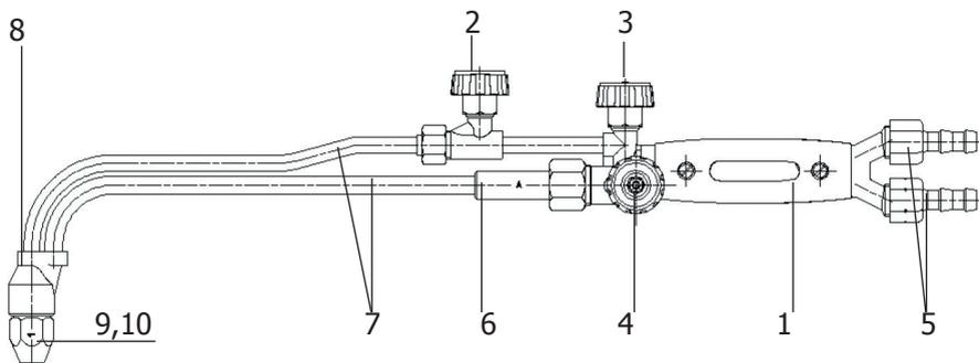
При движении кислорода через инжекторное устройство создается разрежение в смесительной камере, обеспечивающее подачу и смешивание горючего газа с кислородом. Регулирование расхода кислорода и газа осуществляется соответствующими вентилями.
