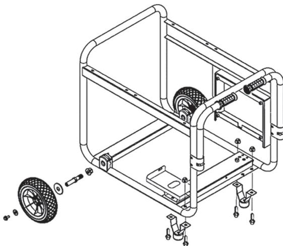
Рис. 4 Установка транспортировочных колес и опор рамы
