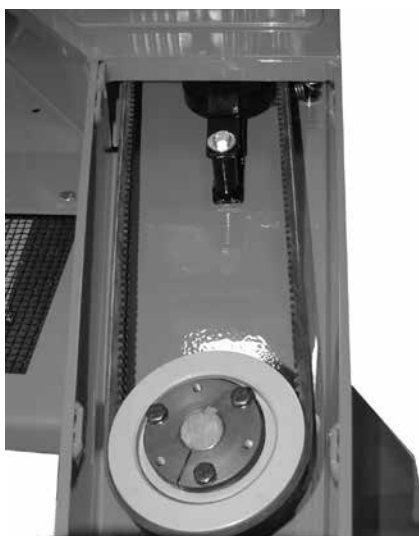
Рис. 5.4. Приводные ремни со снятой верхней крышкой
