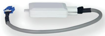
Для установки модуля Wi-Fi необходимо отключить электропитание внутреннего блока. Затем следует открыть лицевую панель и крышку электрических подключений в правой части блока, после чего — соединить разъемы модуля и внутреннего блока, (разъем Wi-Fi располагается под клеммной колодкой межблочного подключения) и закрепить Wi-Fi модуль винтом крепления.
