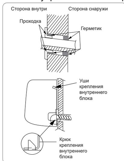
Убедитесь, что внутренний блок надежно закреплен. Для проверки можно немного подвигать внутренний блок вправо-влево.
