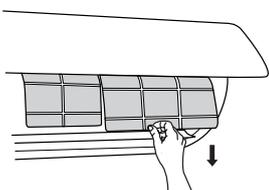
Снимите фильтр. Аккуратно возьмите фильтр за язычок в нижней части, приподнимите, чтобы фильтр вышел из направляющих, и потяните вниз. Постарайтесь не повредить фильтр об острые кромки теплообменника.
