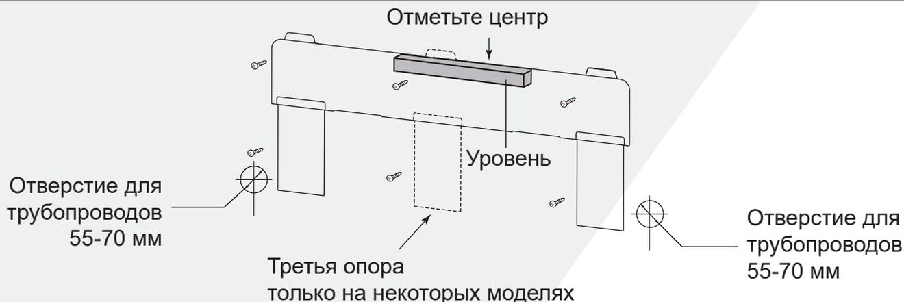
Выберите положение отверстия для трубопровода в соответствии с направлением труб. Отверстие для трубопровода должно быть немного ниже габарита станины внутреннего блока, как показано на рисунке.
