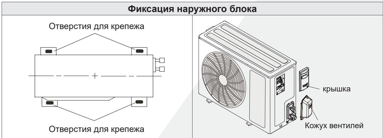
Зафиксируйте наружный блок 4 болтами.
