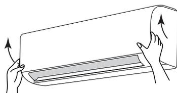
Откройте переднюю панель кондиционера. Двумя руками возьмитесь за панель, как показано на рисунке, и потяните на себя и немного вверх.
