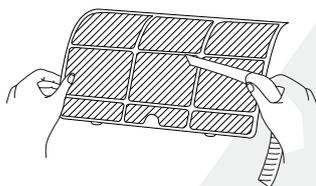
Очистите фильтр от пыли под струей теплой воды (температура воды не более 45°C), или с помощью пылесоса.
