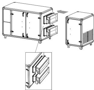
4 Установите кронштейны для надежной фиксации комплекта ODS к установке Торуех и закрепите каждый кронштейн двумя болтами с шестигранной головкой M5×16.
