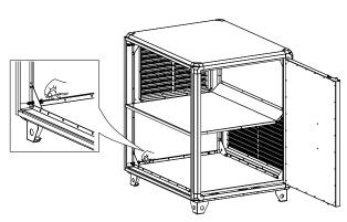
5 Сдвиньте секцию ODS и воздухообрабатывающий агрегат вместе. Проведите кабель от отсечного клапана вдоль внутренней стенки секции ODS и через кабельные вводы.
