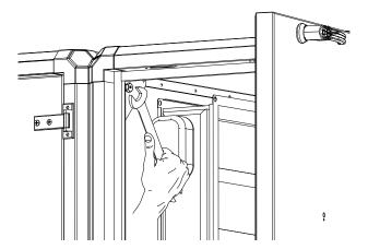
7 Установите угловые кронштейны на верхнюю панель. Закрепите края, зафиксировав нижний край в области между дверцей и рамой.
