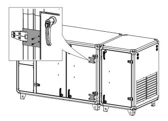
5 Отломите один из перфорированных краев углового кронштейна, который находится на короткой стороне секции ODS (см. рисунок). Установите угловые кронштейны на верхнюю панель. Прикрепите кронштейны, зафиксировав нижний край в области между дверцами и рамой.
