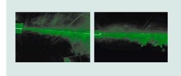
Использование декоративной панели IRYS с эффектом Коанда способствует равномерному распространению струи воздуха в помещении.
