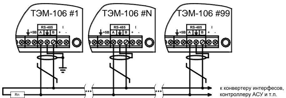
1. Согласующее сопротивление  $R_n$  устанавливается в крайних точках линий связи и должно быть равно волновому сопротивлению кабеля.
