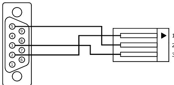
Рис. 7.4 Переходной кабель RS-232C (ТЭМ-106 – АПД)
