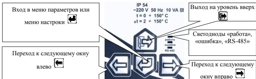
7.1.3 О состоянии теплосчёта можно судить по состоянию трех светодиодов, расположенных на панели управления. Мигание зеленого светодиода свидетельствует о нормальной работе теплосчёта. Мигание красного светодиода сигнализирует о наличии НС, непрерывное свечение – о наличии ТН. Свечение желтого светодиода сигнализирует о передаче данных по интерфейсу RS-485
