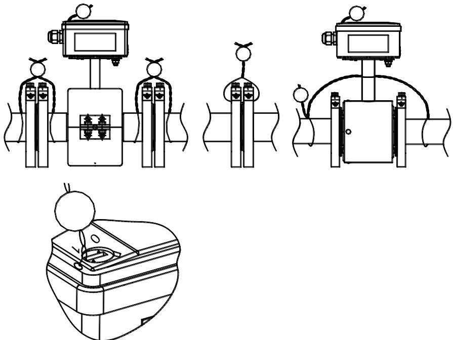
Пример пломбирования ИВБ
