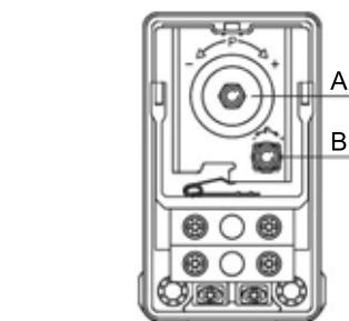
**Slika 1** Tlačna sklopka
