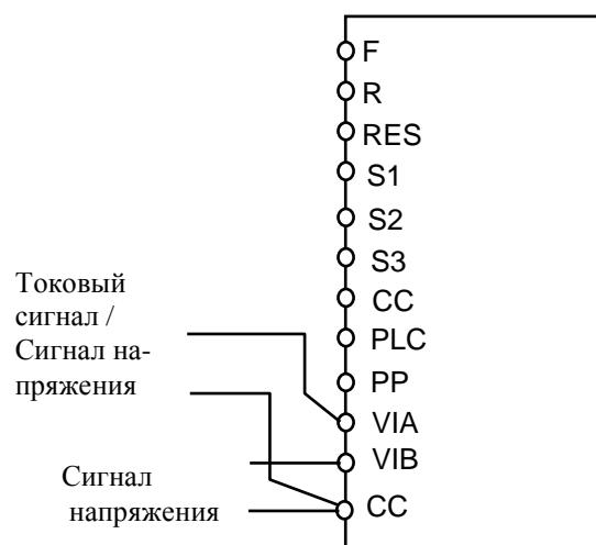
**U-02 = 6** – задание частоты определяется суммарным сигналом VIA и VIB;
