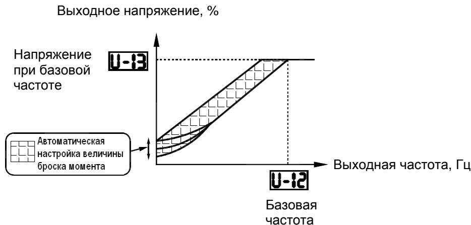
Примечание: Этот тип управления при определенных нагрузках может привести к нестабильности и колебаниям. Если это произойдет, установите **U-14 = 0** и отрегулируйте момент вручную.
