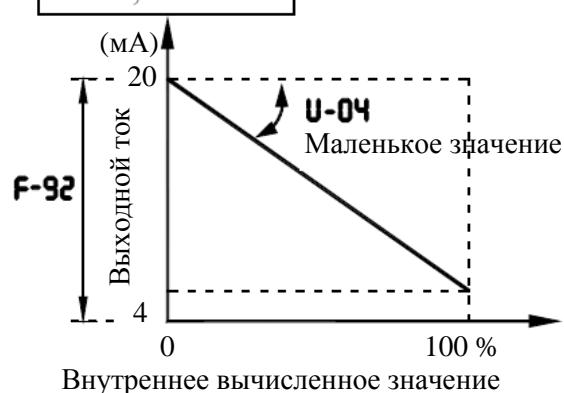
★ Угол наклона характеристики аналогового выхода настраивается параметром **U-04** (см. п. 9.5).
