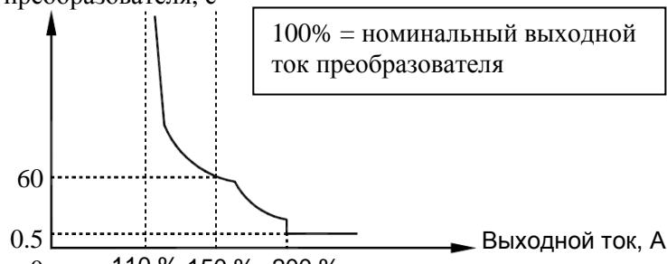
Характеристика защиты преобразователя от перегрузки
