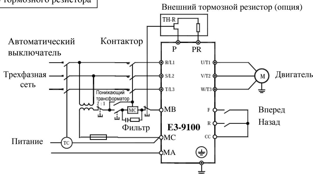
Примечание 1: Обмотка отключения ТС подключается, как показано на рисунке, если автоматический выключатель МССВ используется вместо магнитного контактора МС. Понижающий трансформатор нужен для преобразователей класса 380 В.
