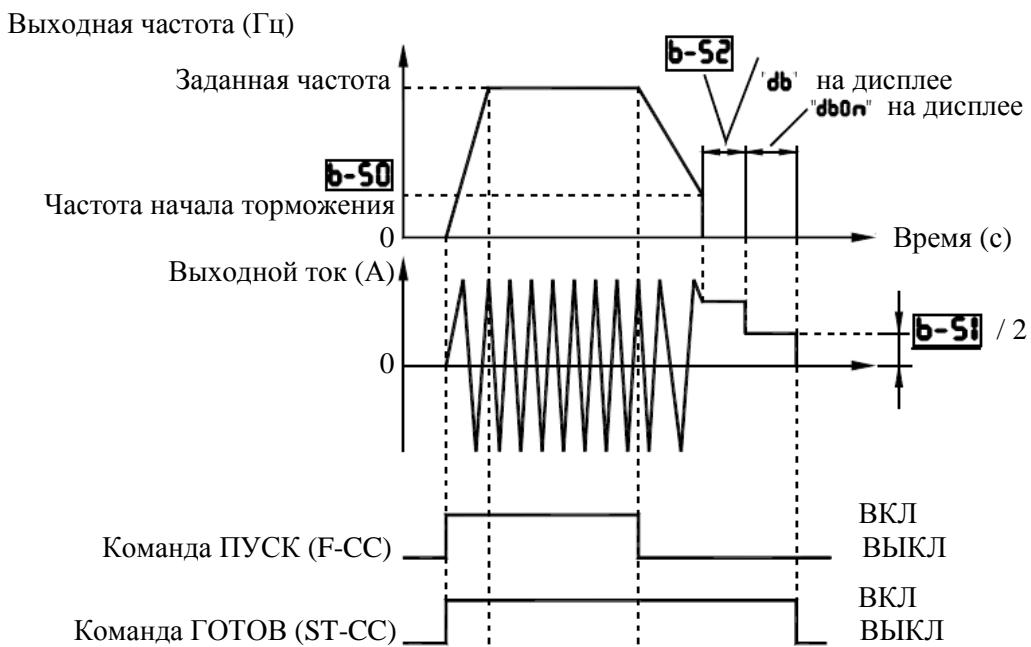
Примечание 1: Вал также можно зафиксировать, подавая внешний сигнал торможения постоянным током.
