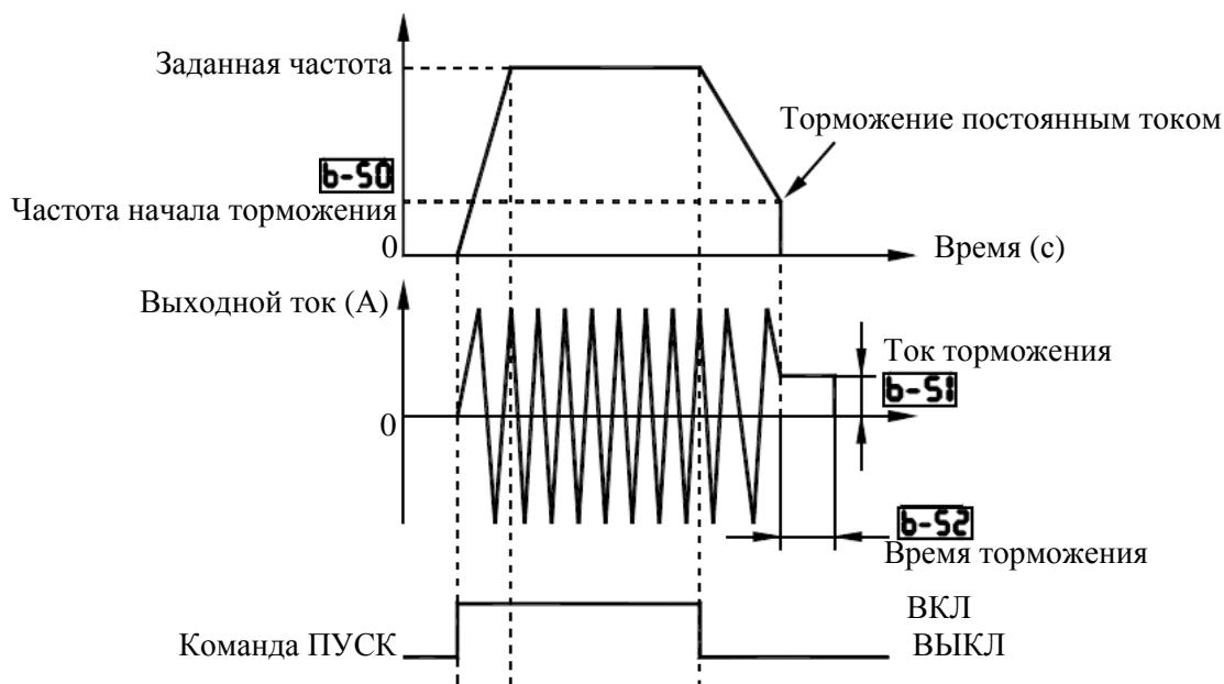
Примечание 1: Во время торможения постоянным током чувствительность защиты от перегрузки повышается. Ток торможения может настраиваться автоматически для предотвращения отключения.
