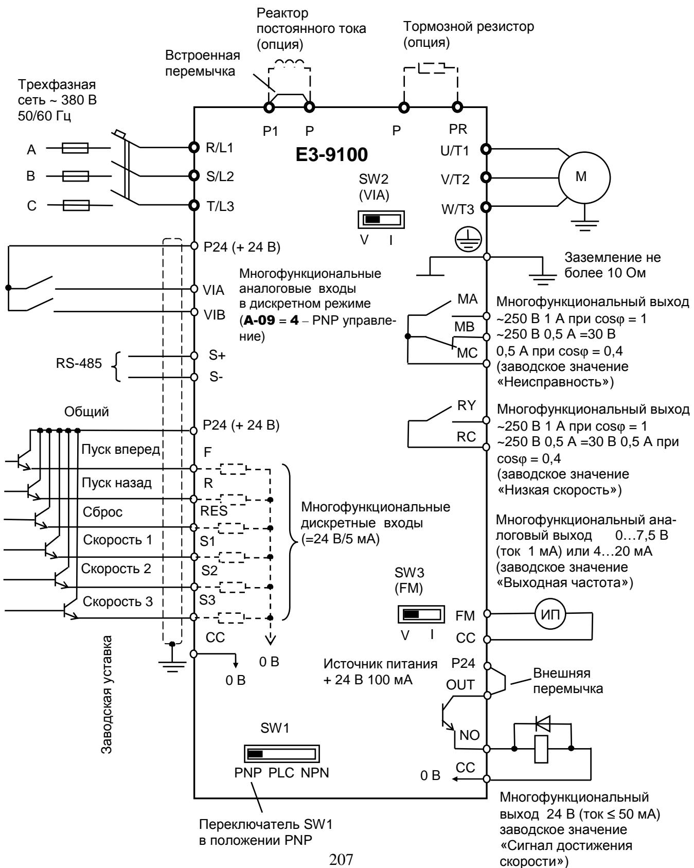
**Приложение 4. Схема подключения с PNP-управлением
