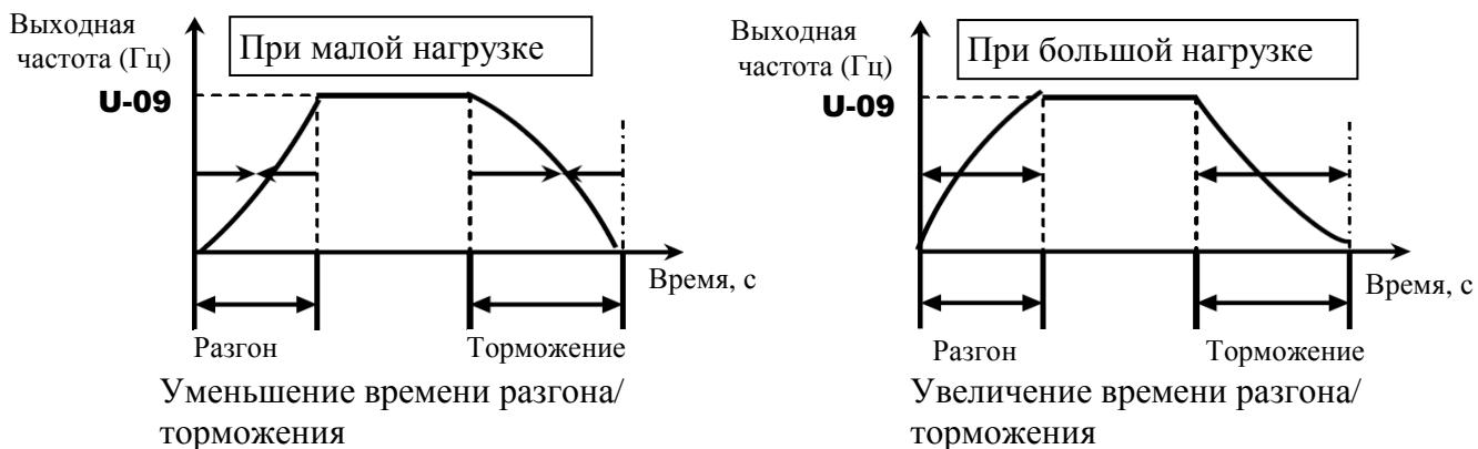
Автоматическая настройка времени разгона и торможения в соответствии с нагрузкой:
