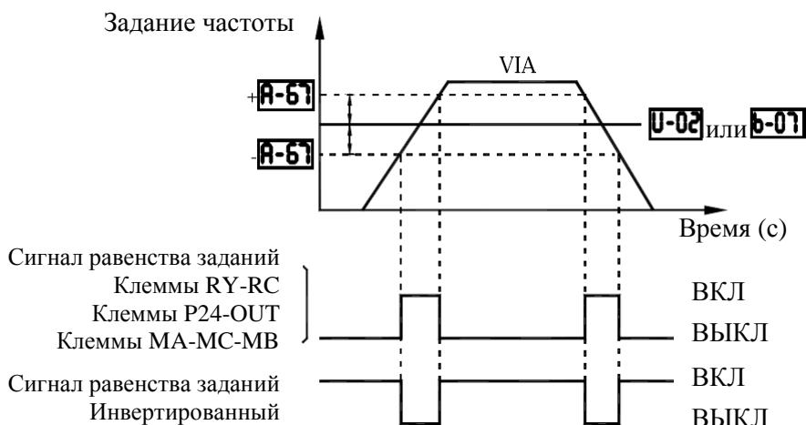
Примечание: Эта функция может использоваться, например, для подачи сигнала о равенстве задания и обратной связи при использовании ПИД-регулирования.
