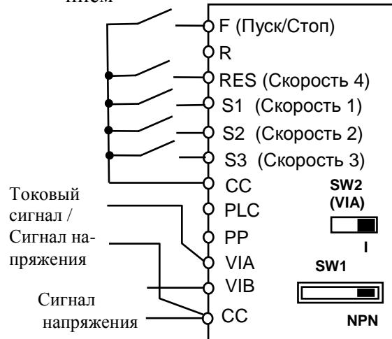
**U-01 = 0** – Пуск/Стоп с клеммной колодки;
