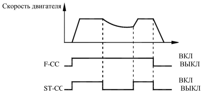
☆ Установка **C-01 = 2** или **3**: Функция работает после размыкания и повторного замыкания цепи ST-CC.
