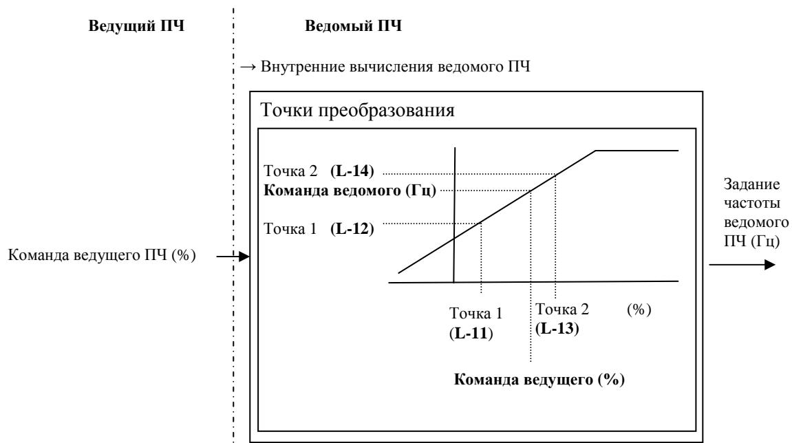
Для получения заданных характеристик управления частотой необходимо для каждого из ведомых ПЧ определить значения параметров **L-11... L-14**, соответствующих двум точкам характеристики преобразования: при минимальном и максимальном значении частоты ведущего ПЧ.
