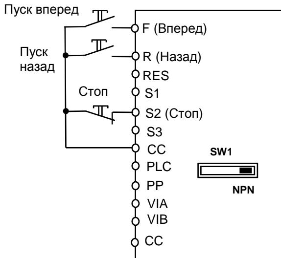
**U-01 = 0** – управление (Пуск/Стоп) с клеммной колодки;
