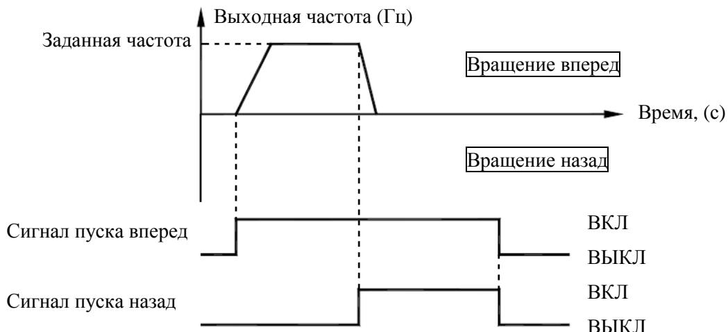
**A-05 = 0** (Реверс): При одновременной подаче команд F и R двигатель вращается в обратном направлении
