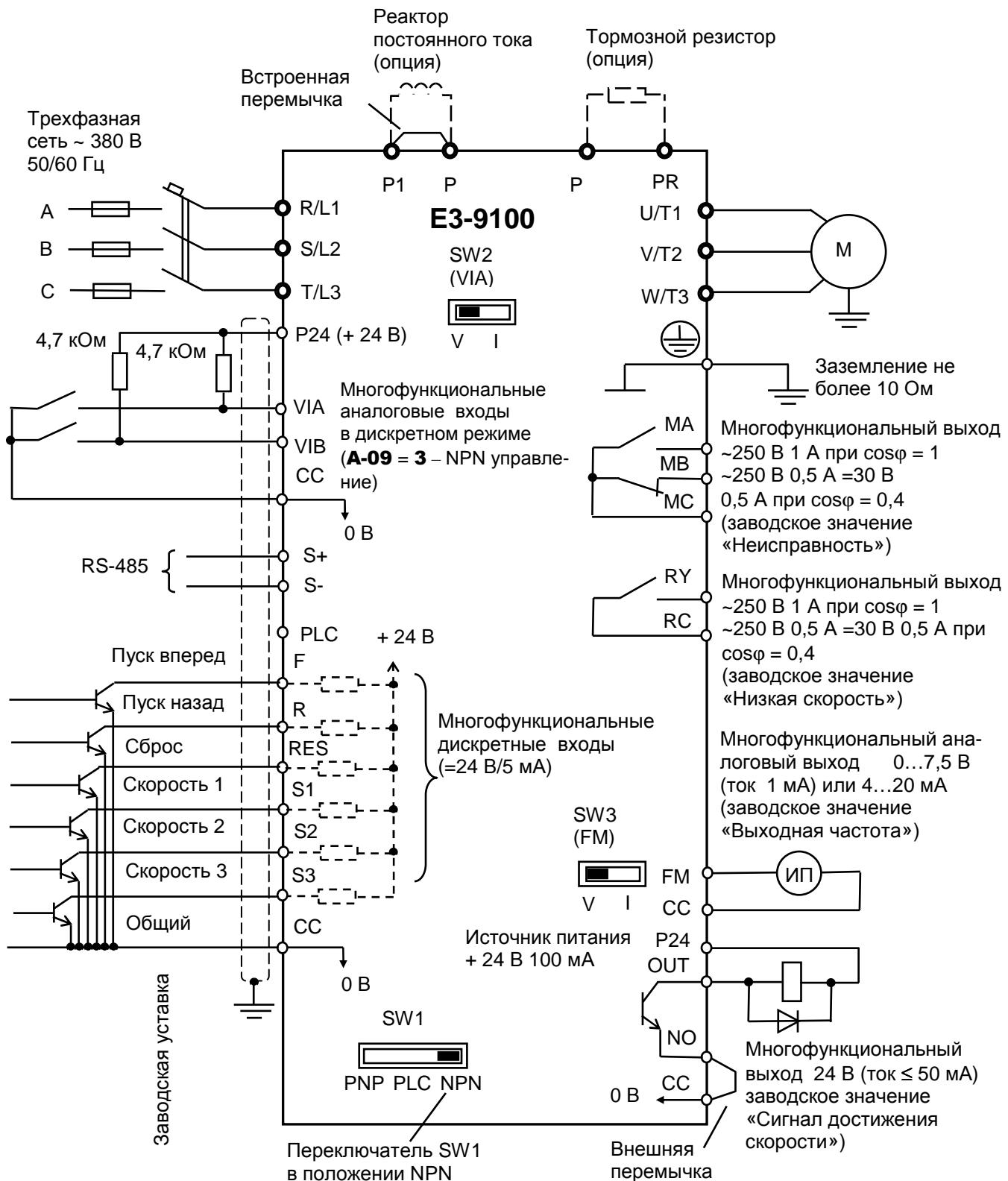
**Приложение 2. Схема подключения с NPN-управлением
