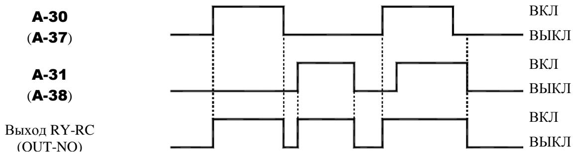
(3) При **A-39 = 1** или **2** выходной сигнал является результатом логической операции «И» или «ИЛИ», выполненной над функциями, назначенными данному выходу:
