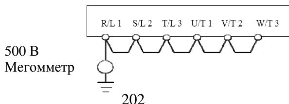
7. Не проверяйте преобразователь на давление. Такая проверка может повредить его компоненты.
