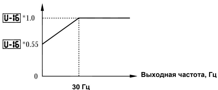
Примечание: Уровень начала работы функции защиты от перегрузки стандартного двигателя фиксирован и равен 30 Гц.
