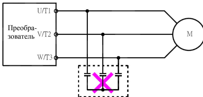
Удалите конденсаторы коррекции коэффициента мощности и фильтры подавления импульсных помех.
