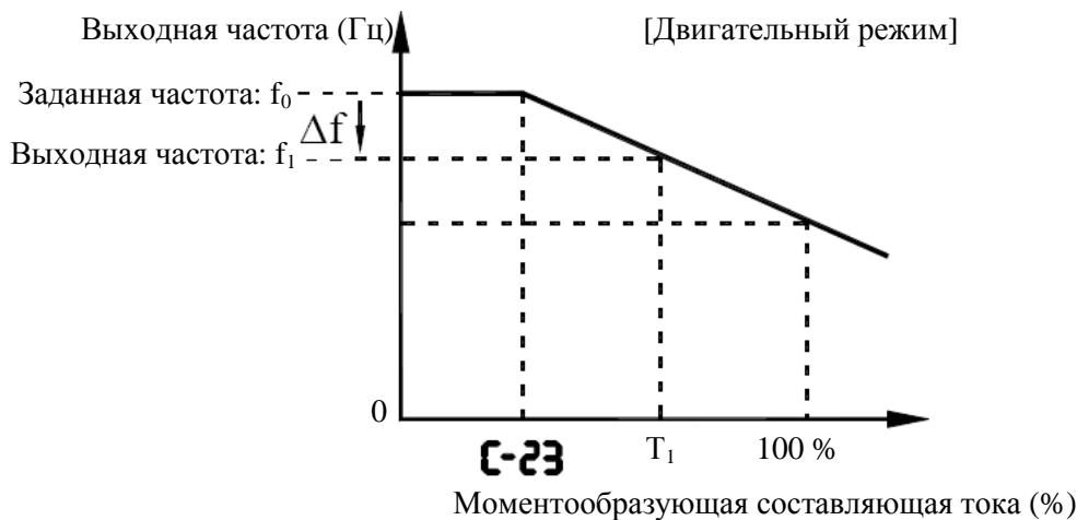
☆ Функция управления снижением основана на функции работы нагруженного двигателя на частоте  $f_1$  (Гц) ниже заданной частоты  $f_0$  (Гц) на величину снижения  $\Delta f$  (Гц) в зависимости от моментообразующей составляющей тока  $T_1$  (%) (См. рисунок выше).
