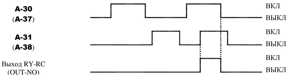
(2) Если **A-39 = 3**, то выходной сигнал будет активен при активности любой из назначенных функций данному выходу:
