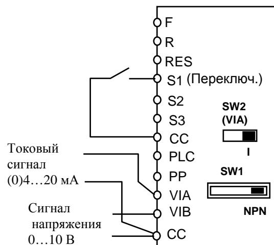
**b-00 = 0** – переключение **U-02/b-07** внешним дискретным сигналом;
