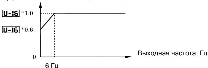
Уровень начала оценки перегрузки двигателя с независимым обдувом
