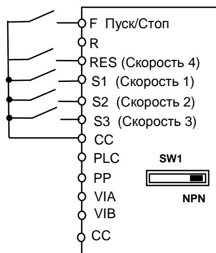
**U-01 = 0** – Пуск/Стоп с клеммной колодки
