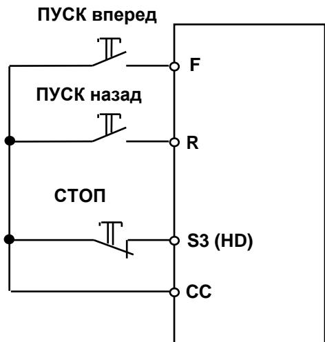
При назначении клемме функции HD (прекращение работы) необходимо замкнуть ее для перевода преобразователя в режим готовности к пуску, и разомкнуть для останова.
