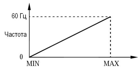
**U-02=1** – задание частоты сигналом на входе VIA
