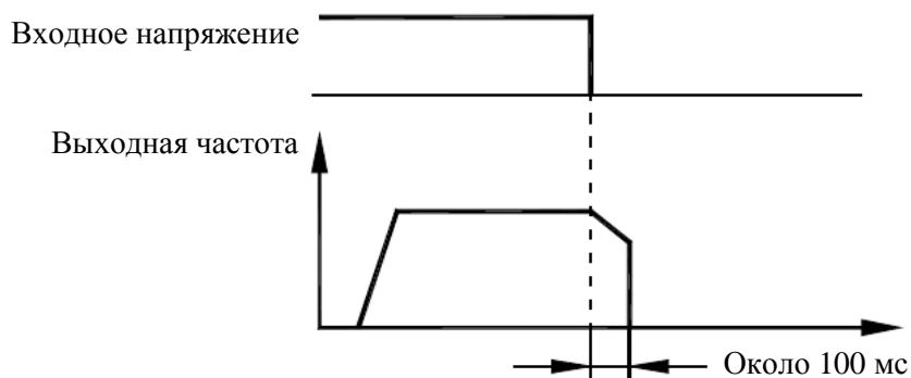
Время, в течение которого может продолжаться работа двигателя, зависит от инерционности механизма и состояния нагрузки. Перед использованием функции проведите проверочные испытания.
